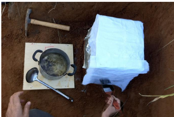
Figura 97 – Bloco indeformado de solo sendo parafinado.
