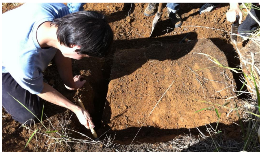
Figura 96 – Abertura de sulcos nas laterais do bloco indeformado de solo.
