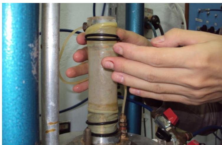
Figura 109 – Colocação da membrana de borracha, anéis de borracha e do cap superior no corpo-de-prova.
