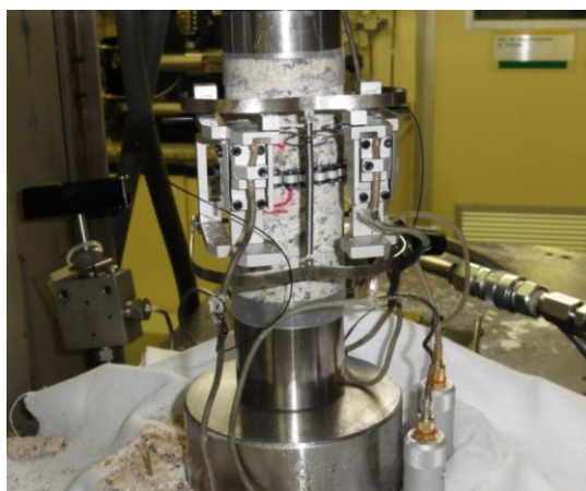
Figura 115 – Instrumentação de um dos corpos-de-prova para início do ensaio de compressão simples.
