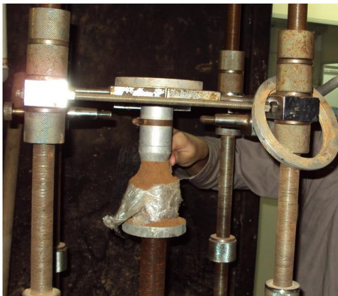
Figura 107 – Preparação do corpo-de-prova do ensaio triaxial para solo.
