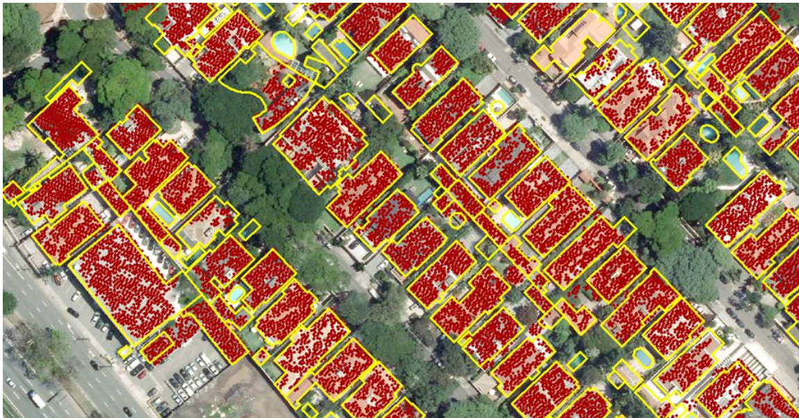
Figura 6.2: Pontos classificados como edificações (em vermelho) e vetores de referência (em amarelo).
