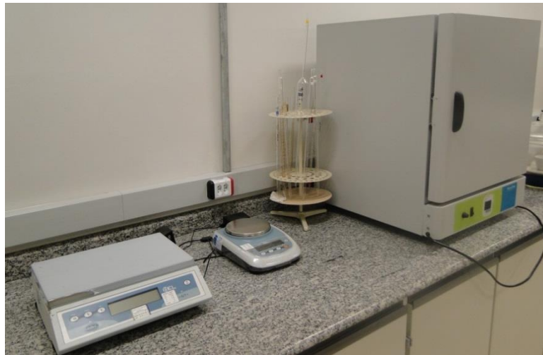
Figura 07 – Balanças de precisão e estufa usadas nas análises granulométricas. Foto do Autor
