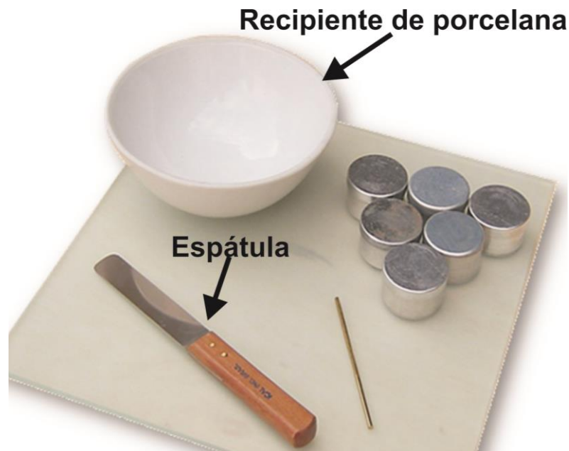
Figura 13 –Espátula e recipiente de porcelana, usados nas análises de limite de liquidez e de plasticidade. Imagem alterada do site www.fortest.com.br .
