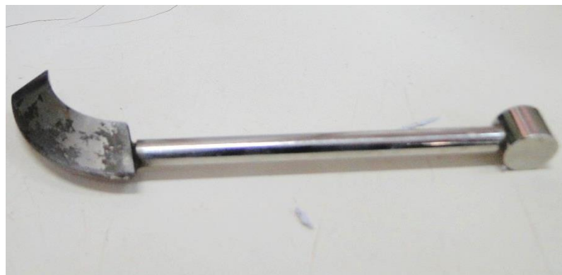
Figura 15 – Cinzel utilizado para fazer a ranhura na amostra colocada no aparelho Casagrande, 1 centímetro de espessura . Foto do Autor.
