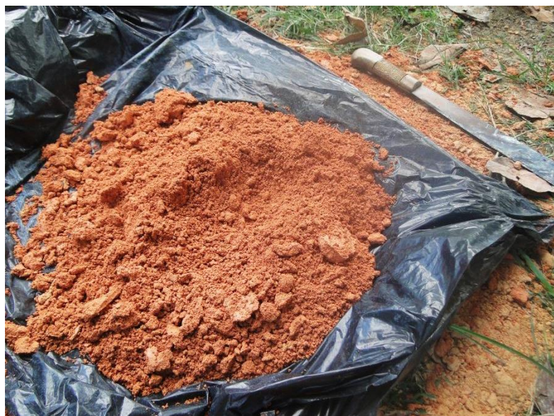
Figura 05 – Amostra retirada do furo de sondagem ST-01, no bairro Jorge Teixeira, sobre lona, para análise tátil-visual e coleta. Data 15/07/2013. Foto do Autor.
