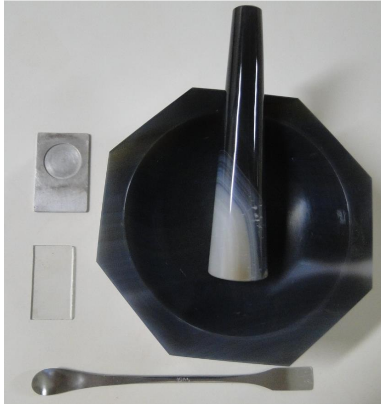
Figura 19 – Gral de ágata, soquete, porta amostra e placa de vidro, utilizados para a preparação da amostra a ser analisada no Difratorômetro de raios-X. Foto do Autor
