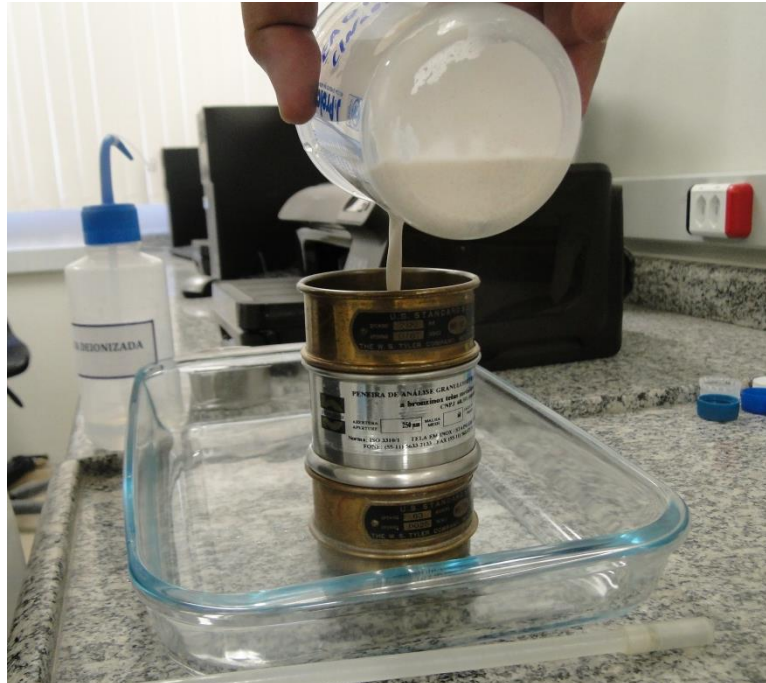
Figura 09 – Peneiras utilizadas para ensaio granulométrico por peneiramento. Foto do Autor.
