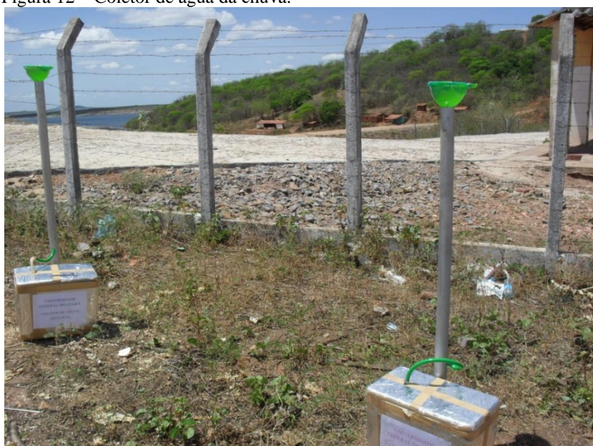
Figura 12 – Coletor de água da chuva.
