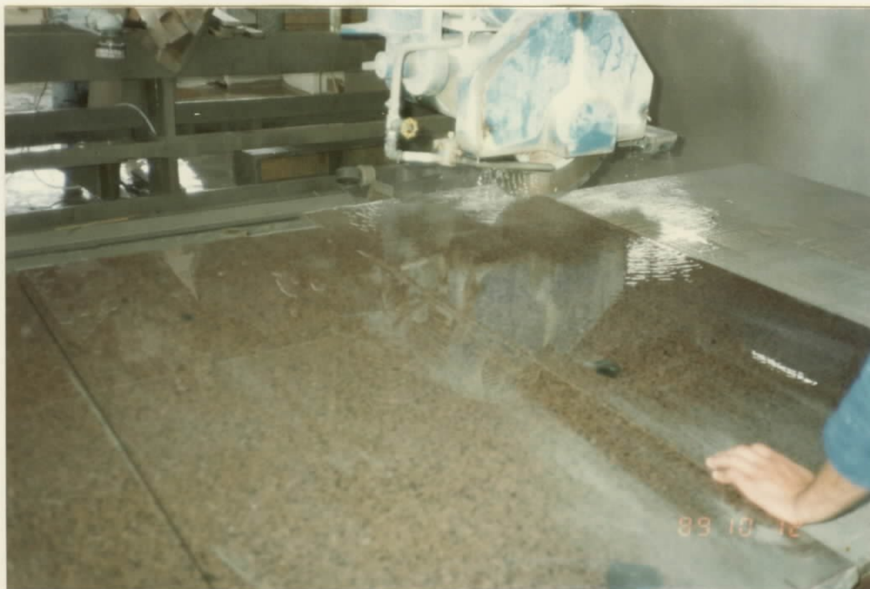
Foto 23: lustração manual de peça recortada.
