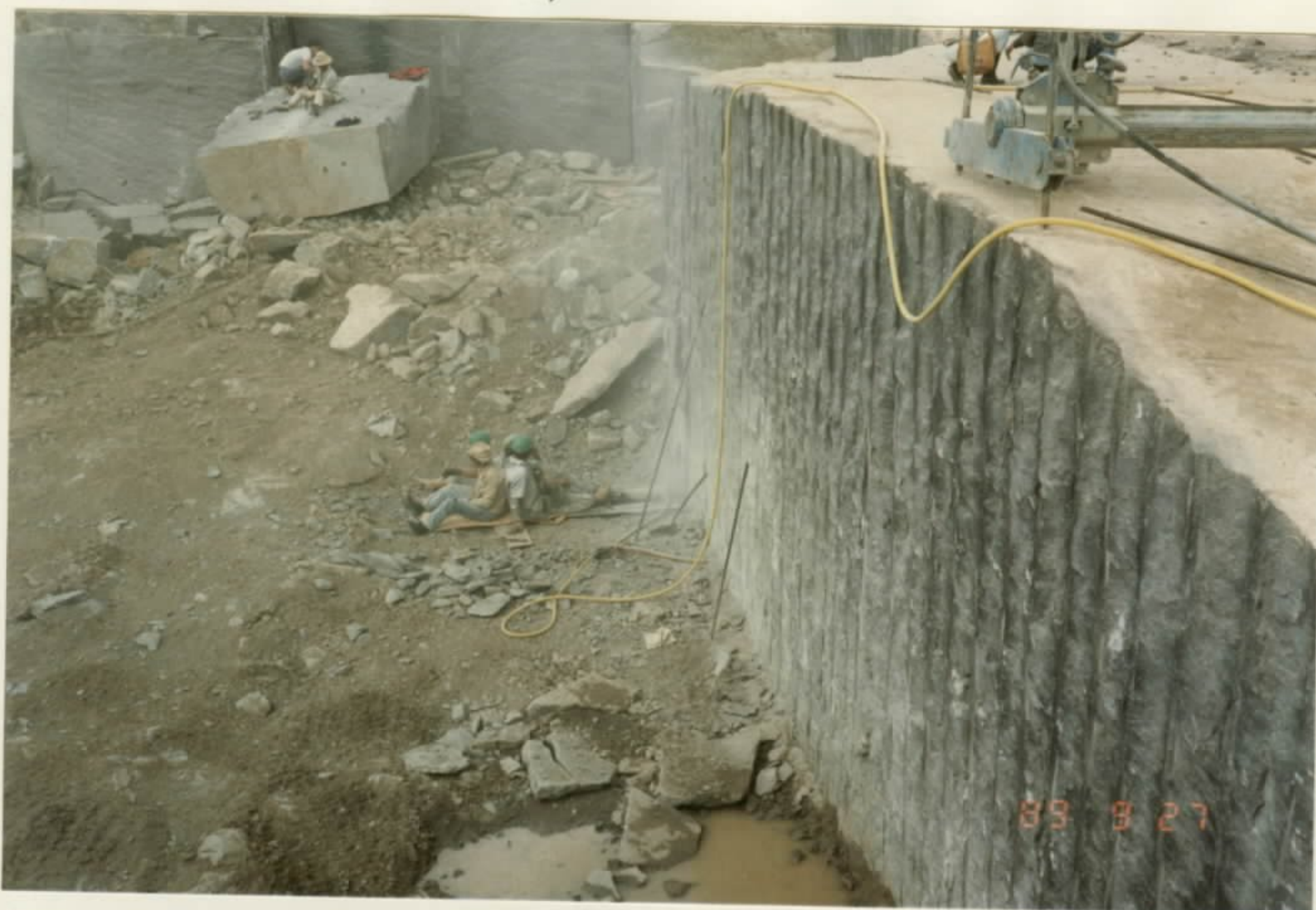
Foto 7: perfuração com martelete para permitir a "petecagem" horizontal.
