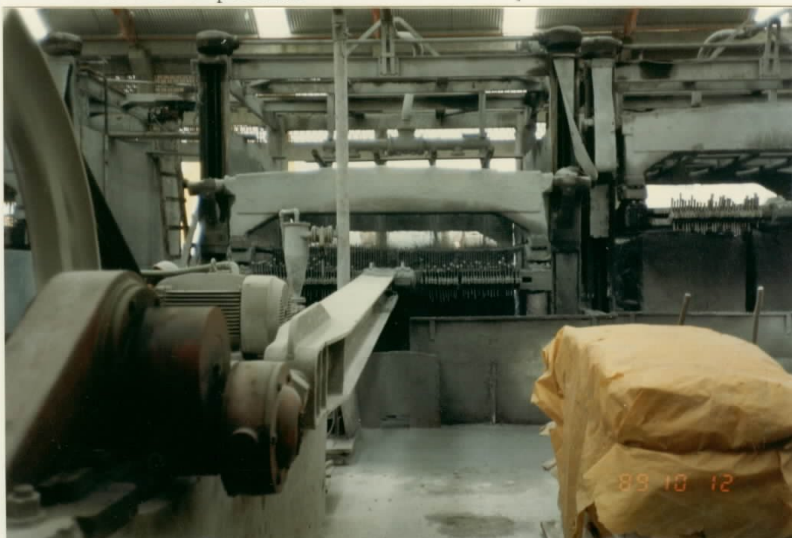
Foto 18: tear corta dois blocos cimentados e desdobra 70 chapas ao mesmo tempo.
