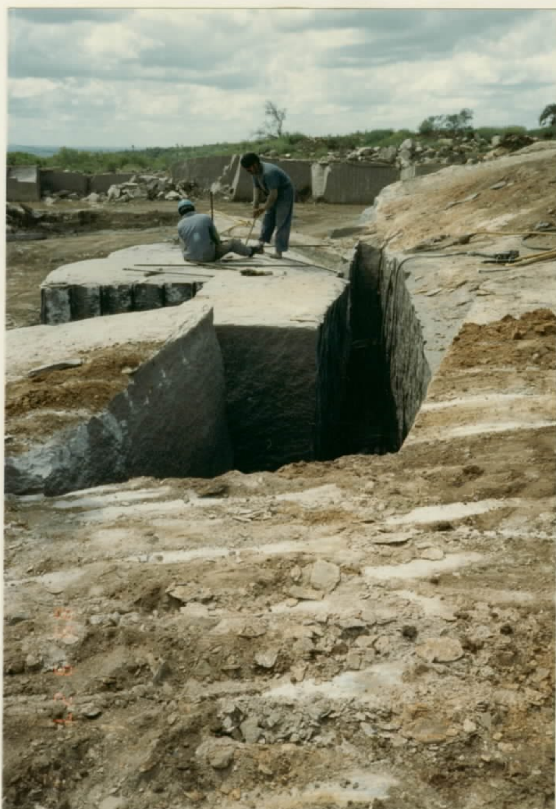
Foto 7: perfuração com martelete para permitir a "petecagem" horizontal.
