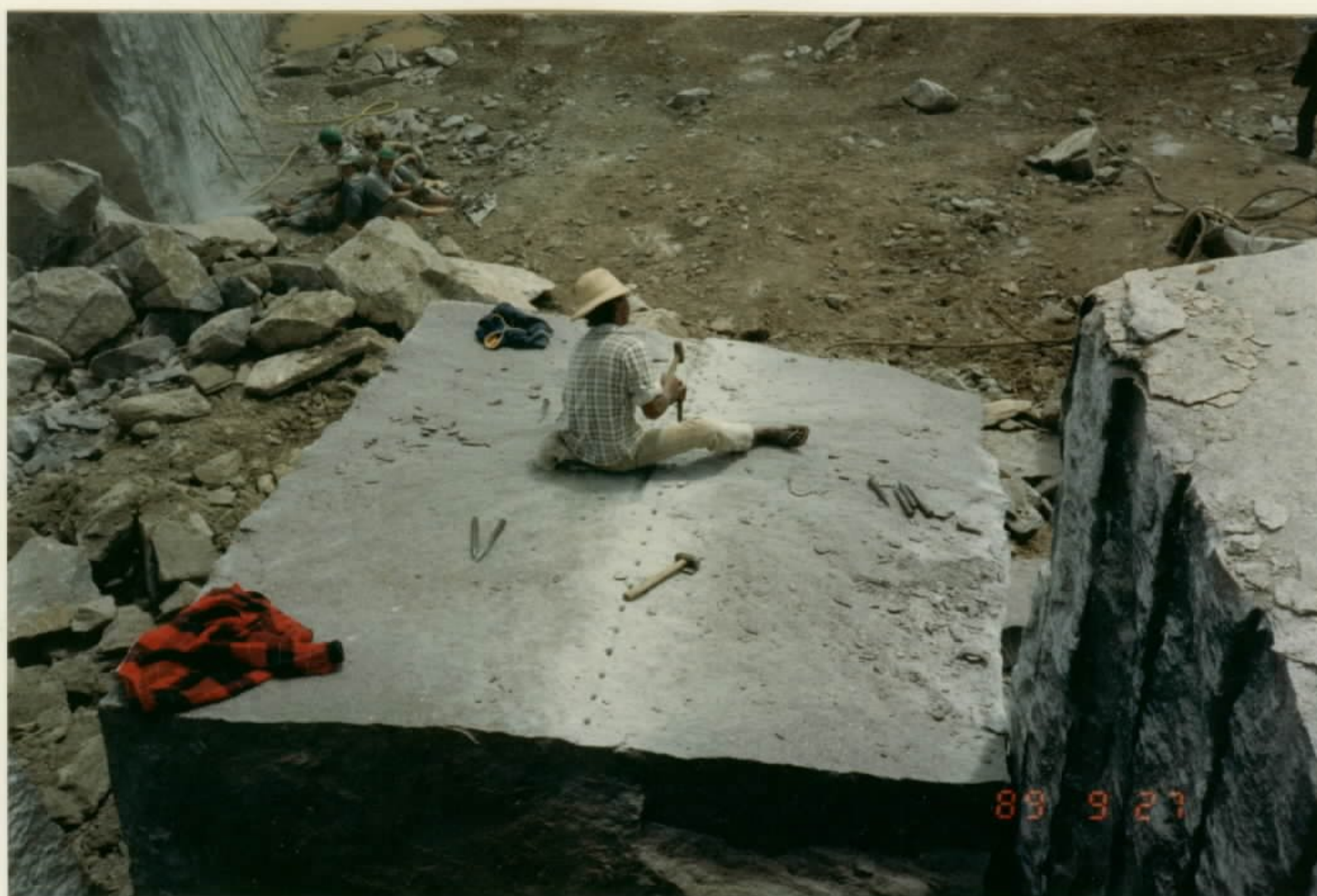
Foto 9: bloco destacado pela "petecagem", em trabalho de dimensionamento manual.
