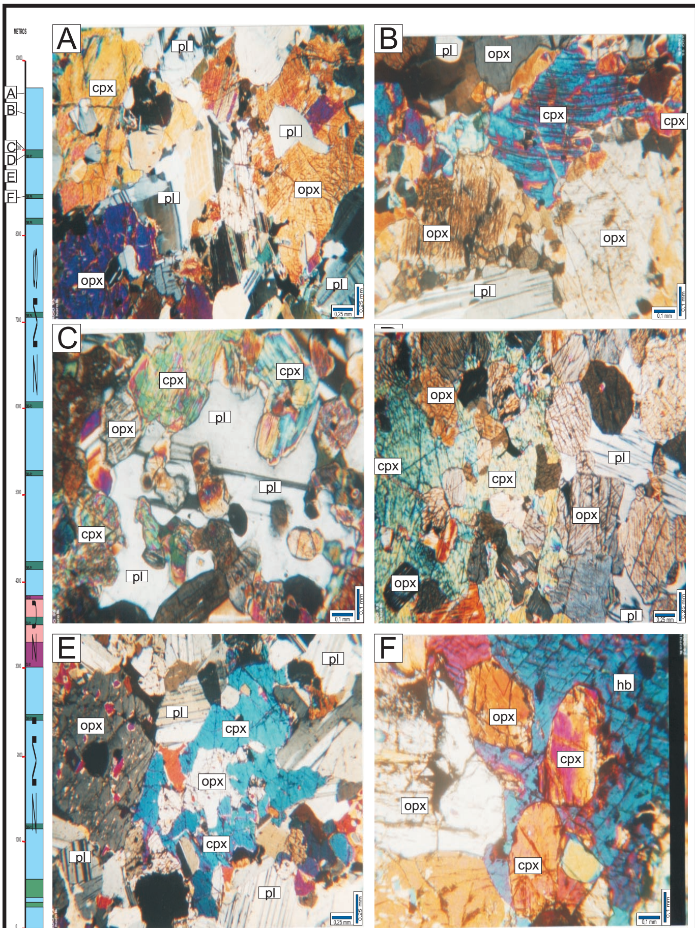
Figura 4.6 - Fotomicrografia dos litotipos da Zona Máfica Superior do Complexo de Cana Brava. Nicóis cruzados. A) Cpx-norito, isotrópico - Membro ZMS-M7. B) cpx-norito, protomilonítico, com deformação incipiente de piroxênios - Membro ZMS-M7. C) Websterito feldspático, isotrópico, com plagioclásio pós-cumulus (icocristal) - Membro ZMS-P7. D) Websterito feldspático, isotrópico, com clinopiroxênio pós-cumulus. Membro ZMS-P7. E) Gabronorito, isotrópico, de granulação grossa, com clinopiroxênio pós-cumulus - Membro ZMS-M6. F) Bi-hb-websterito feldspático, isotrópico e textura mesocumulítica. Biotita e anfibólios substituindo piroxênios - Membro ZMS-P6.
