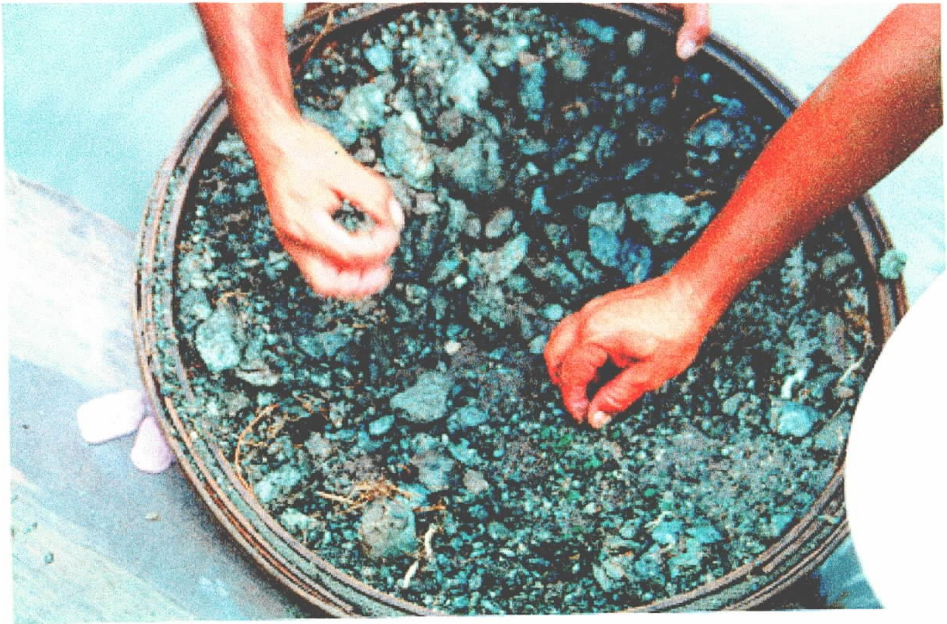
Foto 9 - Catação manual de xisto mineralizado, processo pelo qual são separados os cristais de esmeralda de valor econômico.
