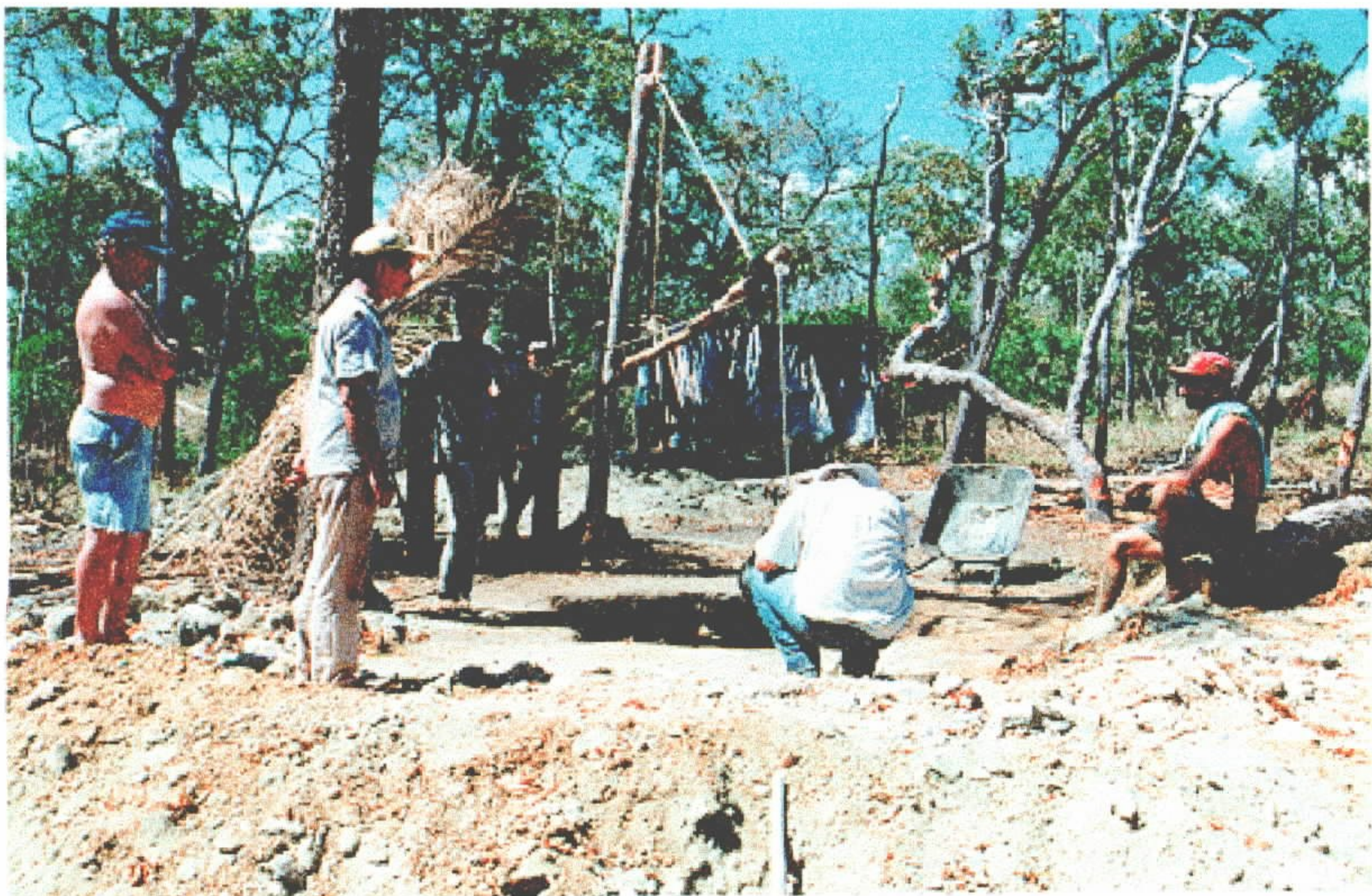
Foto 4 - Abertura de cata com utilização de sarilhos manuais e equipamentos rudimentares (pá e picareta).
