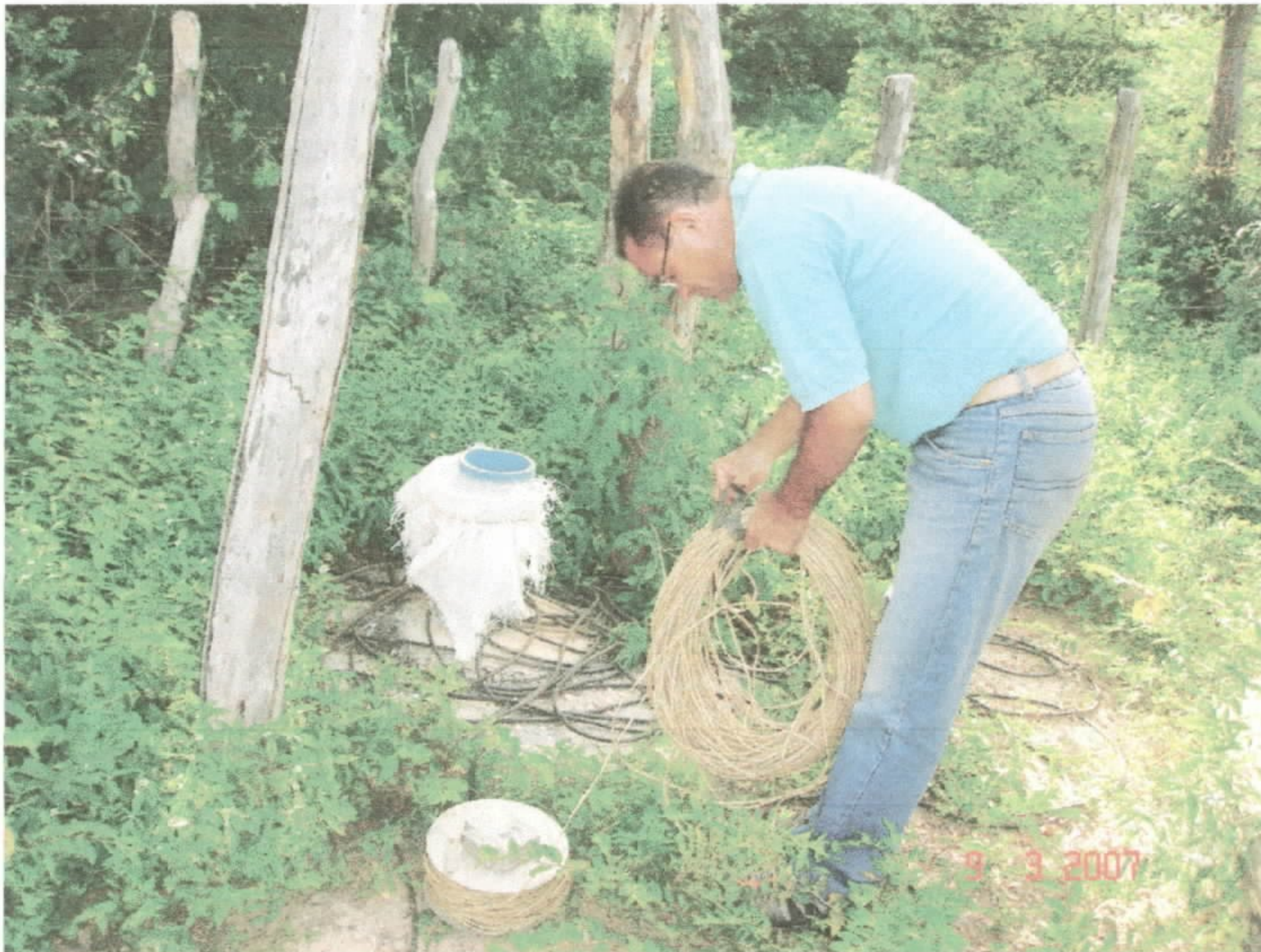
Operações de medição do nível estático na data da visita.
