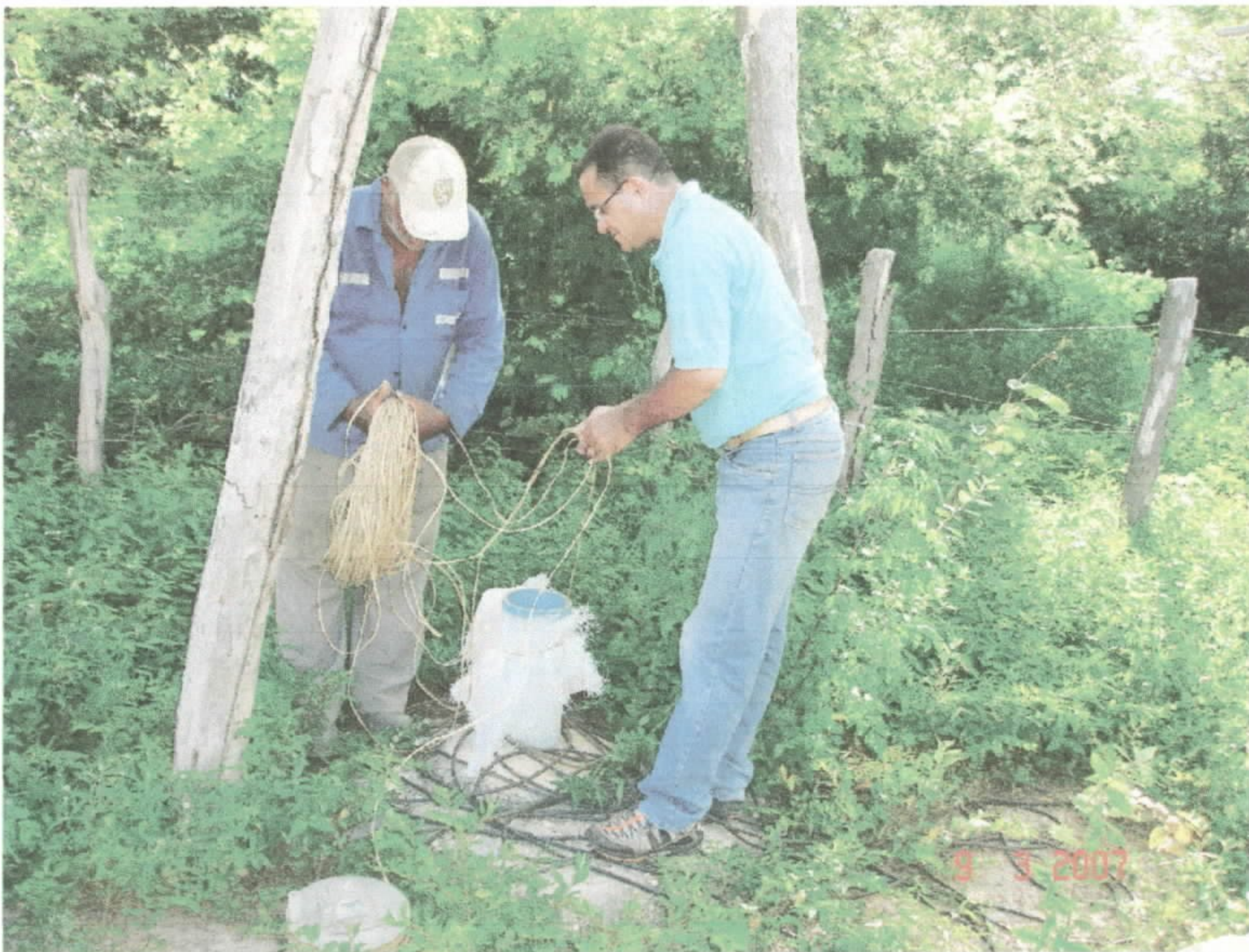
Operações de medição do nível estático na data da visita.
