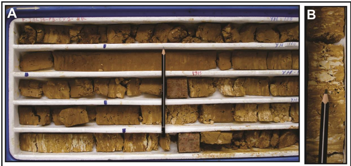
Figura 42. A) testemunho do poço 1AL-30-PB em Alhandra-PB com a fácies Argm. B) Detalhe da fácies Argm apresentando níveis de argila esbranquiçada.
