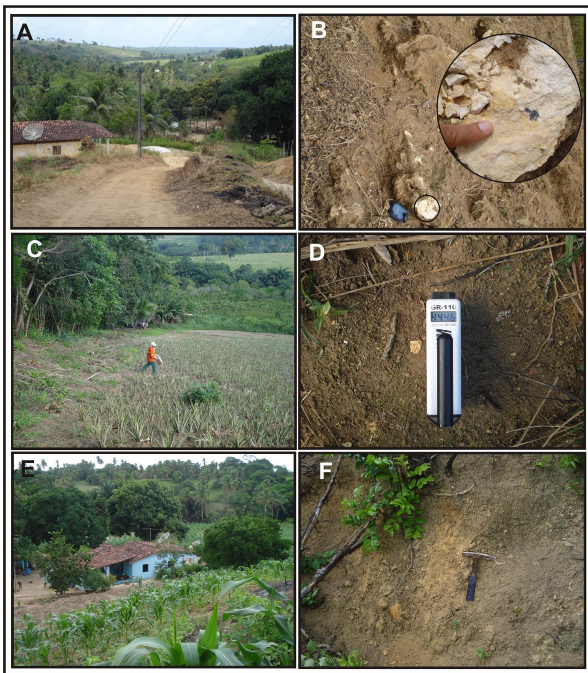
Figura 62. A) Afloramento CM-92. B) Detalhe do solo no CM-92 com fragmentos de fosforito alterado com detalhe para mineral de coloração escura. C) Ponto CM-93 e em D) cintilometro registrando solo anômalo com fragmentos de fosforito. E) Ponto CM-90 com detalhe para solo com uma grande quantidade de blocos de fosforito.
