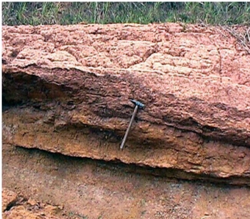
Foto 2: Ídem, observando-se de talhe da alternância de estratos siltoosos e siltoargilosos, mais proeminentes.
