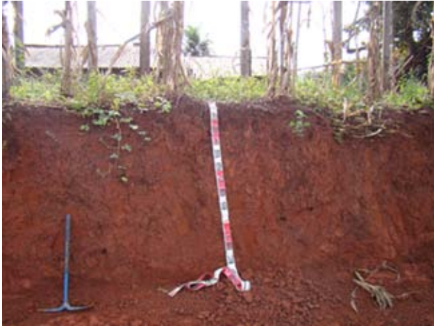
Figura 12.97 - Solo argiloarenoso, estruturado e com alta fertilidade (Nitossolo), oriundo de rocha vulcânica básica. Rodovia BR-010, município Estreito (MA).
