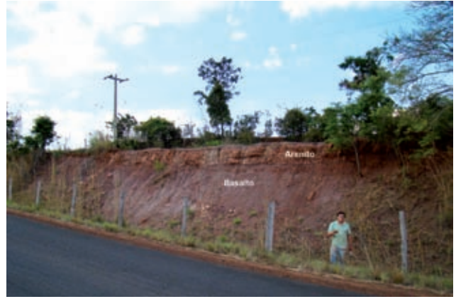
Figura 12.54 - Contato discordante do arenito da unidade geoambiental DSVMPaef com basalto intemperizado do domínio DVM. Rodovia MA-006, município Formosa da Serra Negra (MA).
