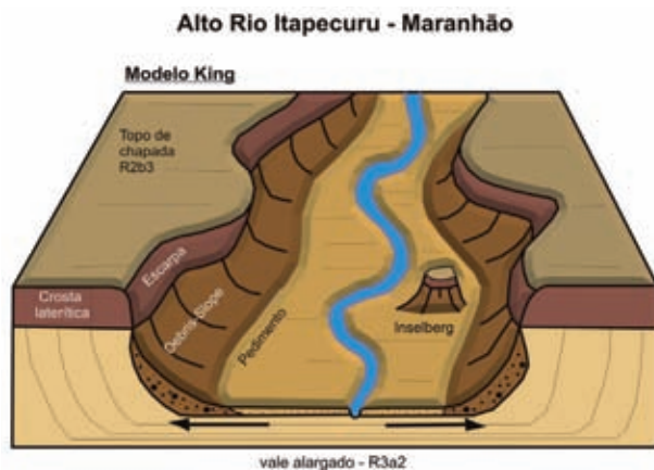
Figura 3.35 - Relevo das chapadas do alto rio Itapecuru caracterizado por extensas superfícies planas sustentadas por cornijas lateríticas ou de arenitos silicificados e demarcadas por abruptas escarpas; observam-se, claramente, processos de abertura e alargamento de vales, recuo lateral das vertentes, geração de pedimentos e formação de inselbergs (modelo King). regional.
