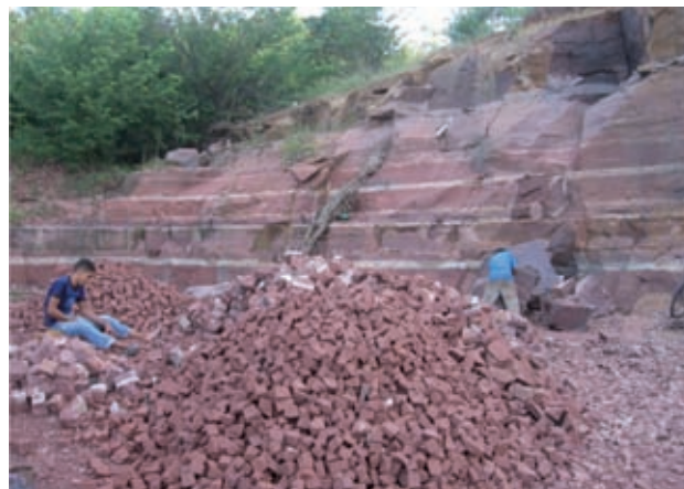
Figura 2.19 - Siltitos e folhelhos silicificados da formação Pedra de Fogo. Fonte: Elem Lopes (2011).
