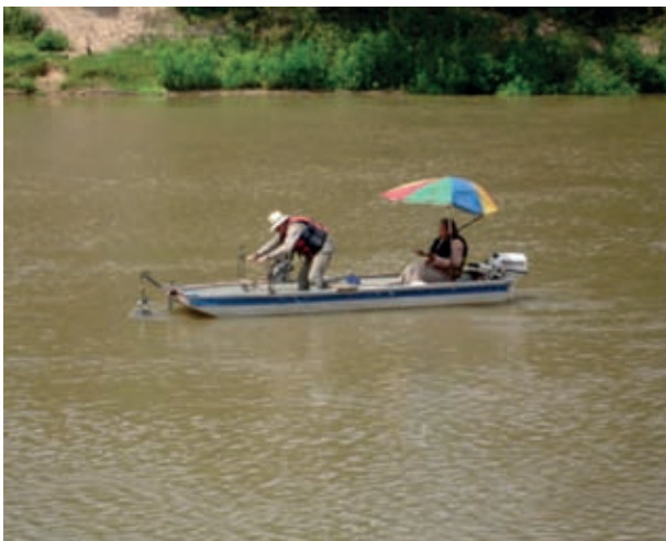
Figura 4.5 - Medição de vazão com molinete no rio Mearim (município de São Luiz Gonzaga, MA).
