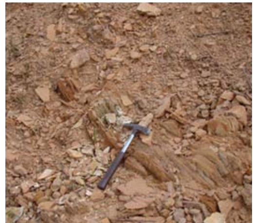
Figura 12.111 - Rocha metamórfica muito intemperizada, com planos de xistosidade subverticais, com feições de deslocamento. Rodovia MA-307, município Centro do Guilherme (MA).
