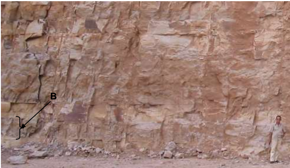
Foto 22: Seção vertical levantada da frente de lavra da segunda bancada da mina ativa da Império Minerações. No presente perfil, o calcário cinza subordinado ( B ) tem maior recorrência e representatividade, suportando camadas com mais de 60 cm. A base é iniciada pelo mesmo calcarenito anteriormente relatado, que continua a preponderar amplamente ao longo do perfil.
