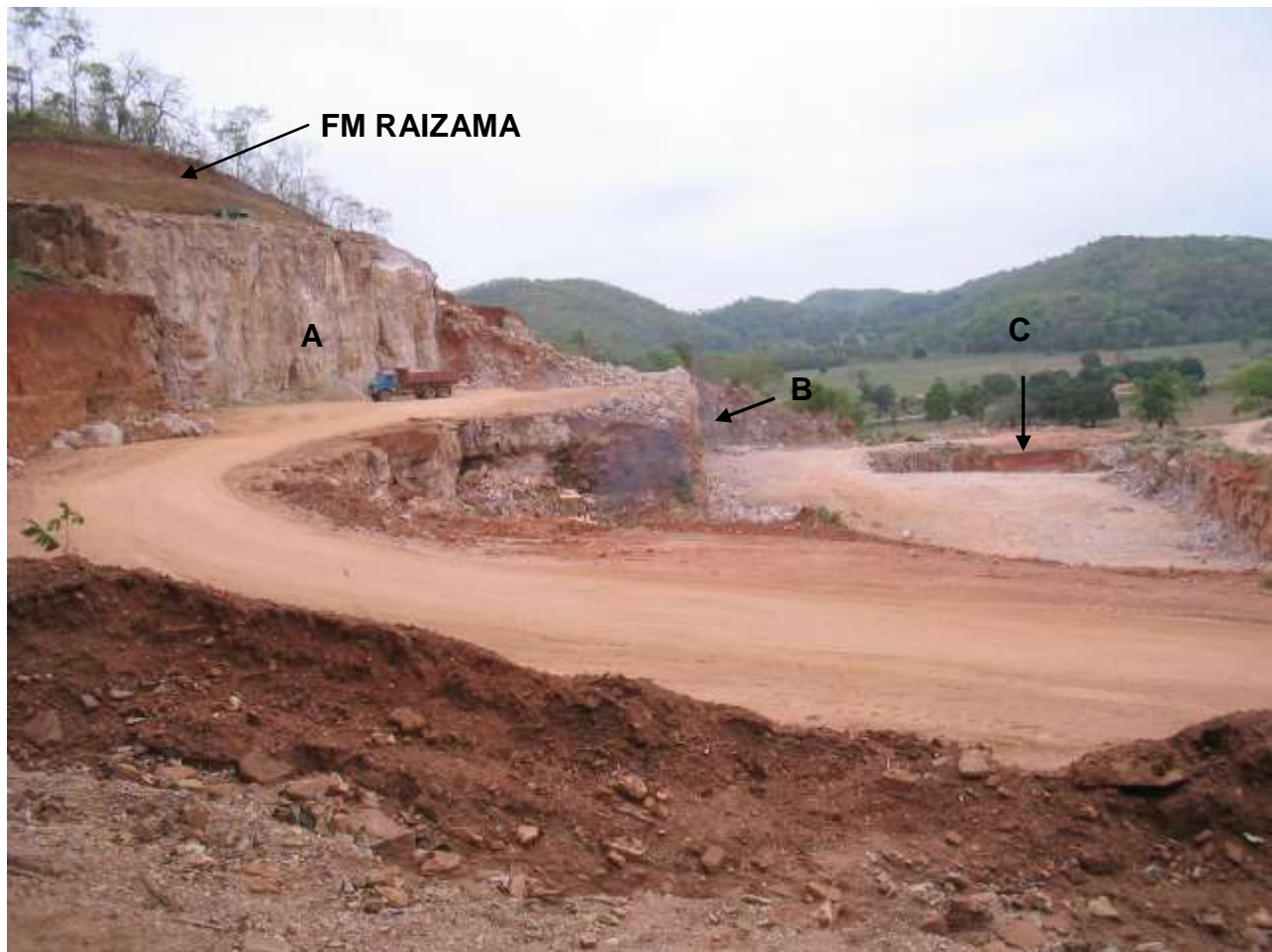
Foto 23: Tomada panorâmica de todo empreendimento mineiro, com visão lateral da frente de lavra da última bancada (A). A direita dela tem-se o pátio relativo à segunda bancada (B), e, ao fundo, a cava pertinente ao pavimento inferior da mina (C). O corte acima da terceira bancada corresponde ao quarto piso da mina, utilizado para sua operacionalização. Neste último pavimento passa a predominar sedimentos siliciclásticos da Formação Raizama.
