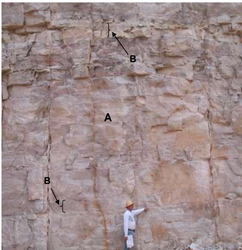
Foto 21: Frente de lavra relativa a primeira bancada da mina ativa da Império Minerações, selecionada para levantamento da seção vertical. O calcário A , dominante no pacote carbonático, corresponde a um calcarenito silicoso creme a branco-amarelado, de granulação fina a média, enquanto calcário B , associado às camadas indicadas pelas setas, uma variedade homogênea cinza-claro de granulação muito fina.
