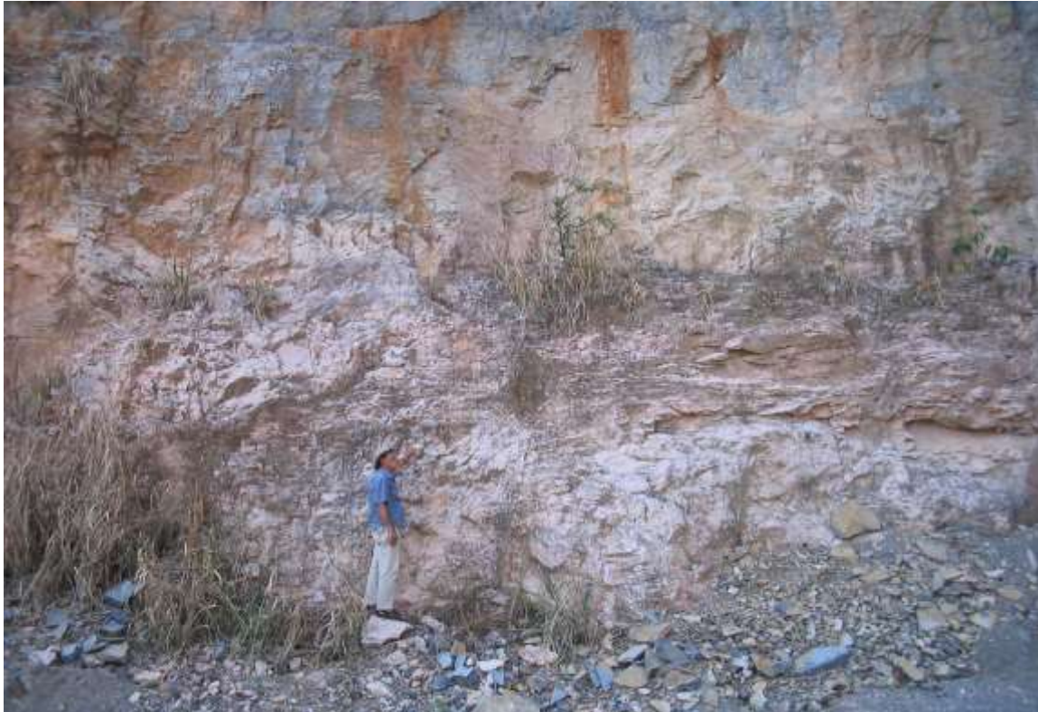
Fotos 38: Calcário dolomítico da seção basal da mina da Terconi, com cerca de seis metros de espessura. A rocha apresenta laminação plano-paralela, textura muito fina e cor creme com nuances para tons amarelo-esbranquiçados a rosados, quando levemente alterados.
