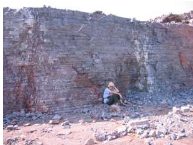
Fotos 30 e 31: À esquerda, vista parcial da bancada inferior da frente de lavra Pimenta da empresa Calcário Tangará, selecionada para levantamento da seção vertical, município de Tangará da Serra. À direita, aspecto do depósito calcário, notavelmente estruturado em camadas regulares decimétricas, plano-paralelas, horizontais.
