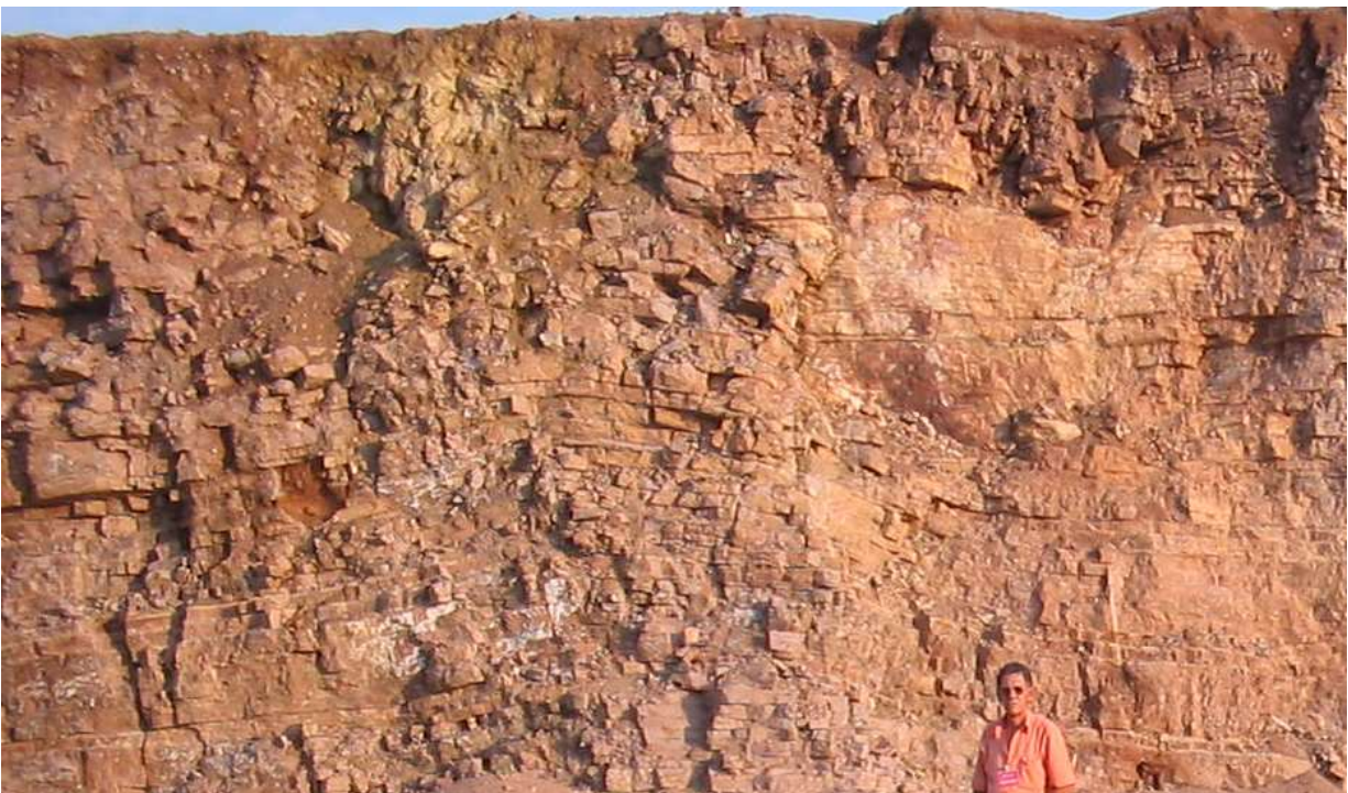
Foto 36: Dobramento suave em calcários laminados, dolomitizados, localmente com deformação mais cerrada, levando a ruptura das camadas com aparente acavalamento em estilo reverso. Frente de lava Abelha, mina da Calcário Tangará, município de Tangará da Serra.
