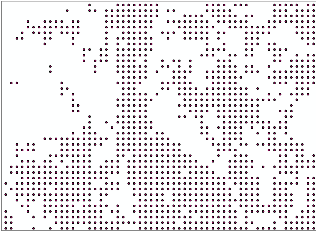
Figura 6.26 - Nuvem de pontos estruturada com espaçamento de grade de 10 metros para o E-Foto
