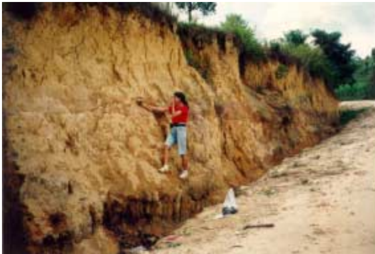
Figura 34 - Sedimentos colúvio-aluviais com provável nível de paleossolo próximo à base do pacote. Corte em estrada secundária a partir da estrada de Queluz a Areias, local SQ-161.
