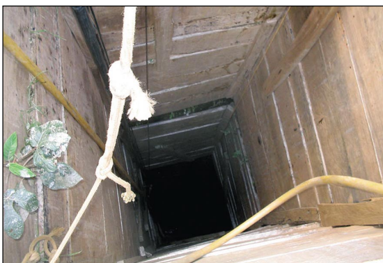
Foto 3.10 – Ponto GR-164. Detalhe do revestimento do shaft do garimpo da faz. Santa Edwiges.
