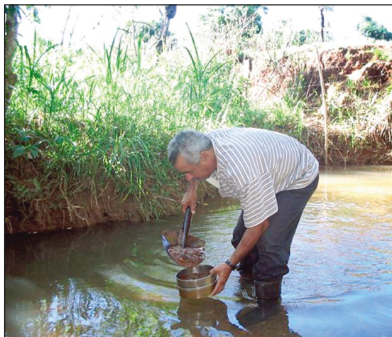
Foto 8.2 – Coleta de sedimentos de corrente utilizando peneiras para evitar os materiais mais grosseiros.
