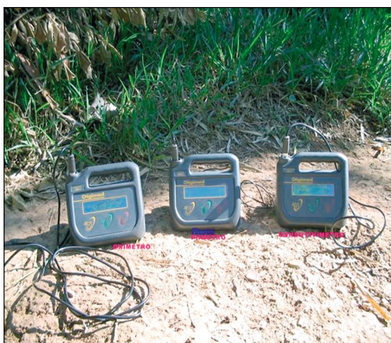
Foto 8.4 – Detalhe dos equipamentos para medir os parâmetros físico-químicos da água.
