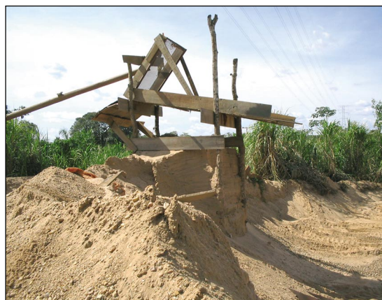
Foto 3.2 – Ponto GS-195. Peneira de separação do material sugado pela draga.
