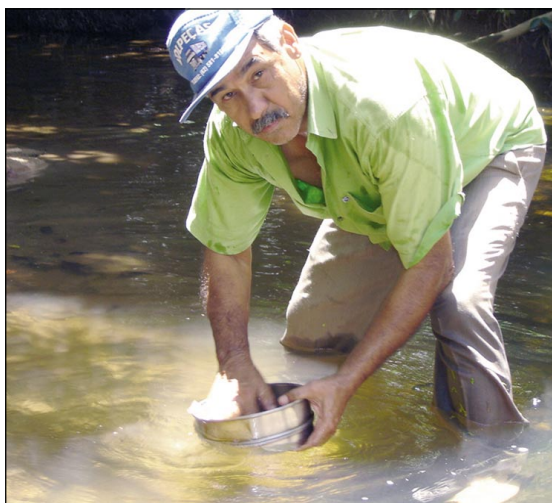
Foto 8.3 – Detalhe na preparação do sedimento de corrente.
