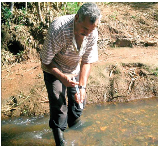
Foto 8.1 – Filtragem utilizando unidades filtrantes e seringa.
