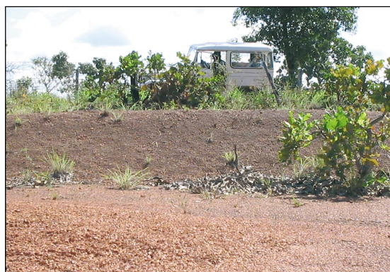
Foto 3.7 – Ponto GR-154. Característica do cascalho laterítico extraído para encascalhamento de rodovias.
