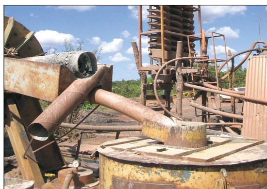
Foto 3.13 – Ponto GR-164. Detalhe do equipamento de separação do ouro no garimpo da faz. Santa Edwiges.
