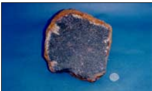
Foto 4.3 – Rocha vulcânica (dacito da Formação Iricoumé) explorada na “Pedreira do Silvino”. Composição mineralógica: K-feldspato, Quartzo, Anfibólio, Calcita, Apatita, Clorita, Óxidos de ferro, Opacos. Obs.: Sem estimativa percentual dos minerais devido à granulação muito fina
