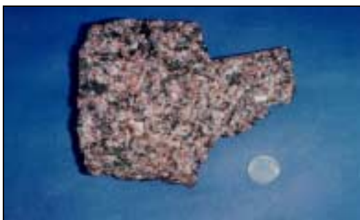
Foto 4.4 – Granito alcalino da Suíte Intrusiva Abonari explorado na pedreira existente no km 200 da BR-174. Composição mineralógica: K-feldspato (45%), Quartzo (25%), Plagioclásio (15%), Anfibólio (ferrohastingsita) (12%), Biotita (3%). Minerais acessórios: Titanita, Opacos, Apatita, Zircão
