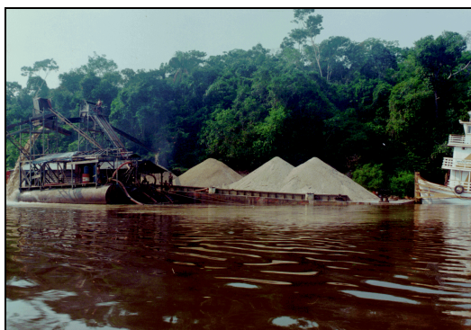
Foto 8 – Conjunto draga-balsa-rebocador em atividade de extração de seixo na calha do rio Uatumã
