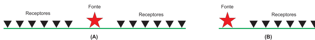
Figura 1.1: Arranjo de receptores do tipo “ split spread ” simétrico em (A) e do tipo “ end-on ” em (B).
