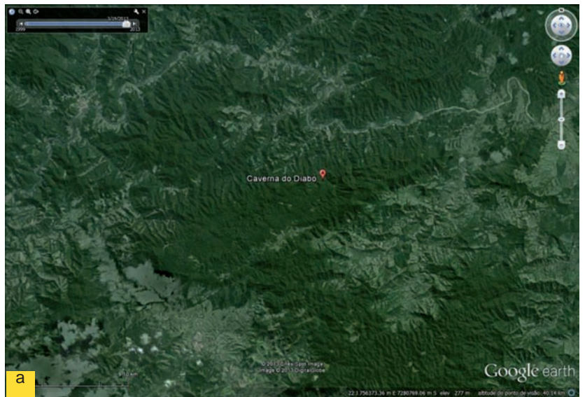
Figura 68 - Imagem na qual se pode notar o forte controle tectônico do relevo da região onde se localiza a Caverna do Diabo, no caso, ao norte da caverna, controlado pela zona de cisalhamento Ribeira; ao sul, pela zona de cisalhamento, ou falha, da Lancinha.
