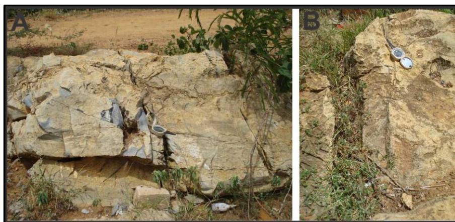
Prancha Fotográfica 2 – Calcários fraturados que afloram nas proximidades do Bairro Ida Cardoso. A – Calcário maciço, cinza, fraturado em várias direções; B – Fratura vertical aberta com direção N-S em calcário de coloração amarelada.
