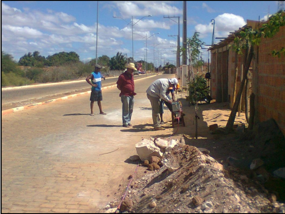
Fotografia 13 – Levantamento de eletrorresistividade na Rua do Cemitério.
