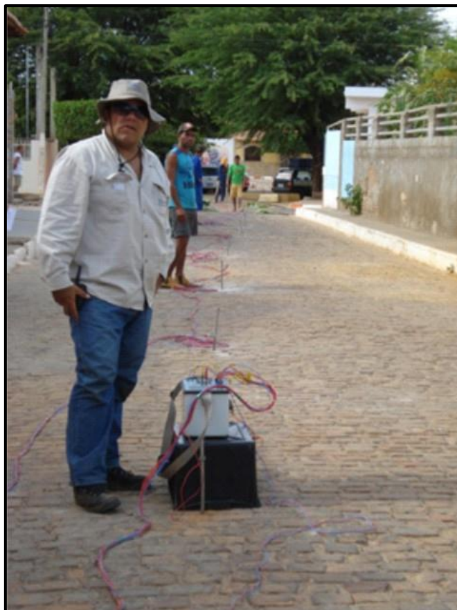
Fotografia 6 – levantamento de eletroresistividade ao longo da Rua Augusto Galvão e na Praça da Fonte.
