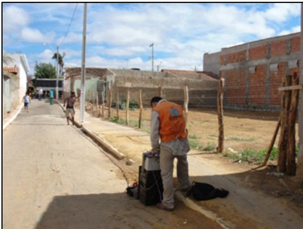
Fotografia 5 – levantamento de eletrorresistividade na Rua José Marcelino, transversal a uma zona de fratura que se propagou a partir da dolina da Fonte de Lapão.
