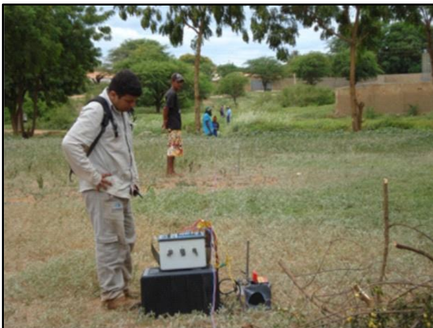
Fotografia 7 – levantamento de eletroresistividade em uma dolina em formação no Bairro Ida Cardoso.
