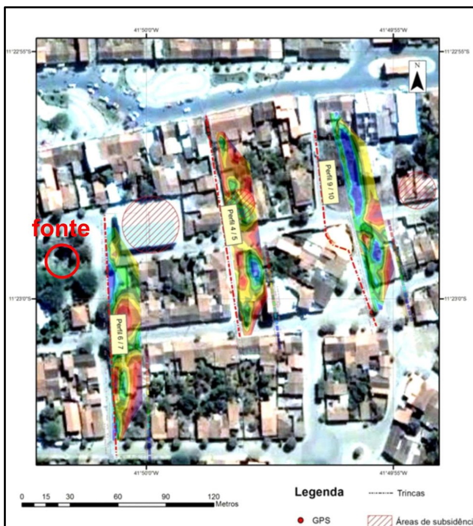
Figura 6 – Localização dos caminhamentos elétricos no centro da cidade de Lapão nas proximidades da fonte. As seções geoeletricas verticais estão rebatidas na horizontal.
