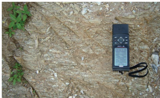
Figura 5.74 – Aspecto da intensa deformação a que foram submetidas as rochas desse domínio; possuem discontinuidades geomecânicas (Riachão do Jacuípe, BA).
