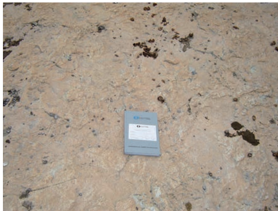
Figura 5.67 – Aspecto isotrópico, sem orientação mineral preferencial (granito de Campo Formoso, BA).
