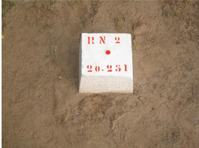
Figura 5.2 - Referência de nível (RN) utilizada para nivelamento geométrico das réguas linimétricas, com referência arbitrária.
