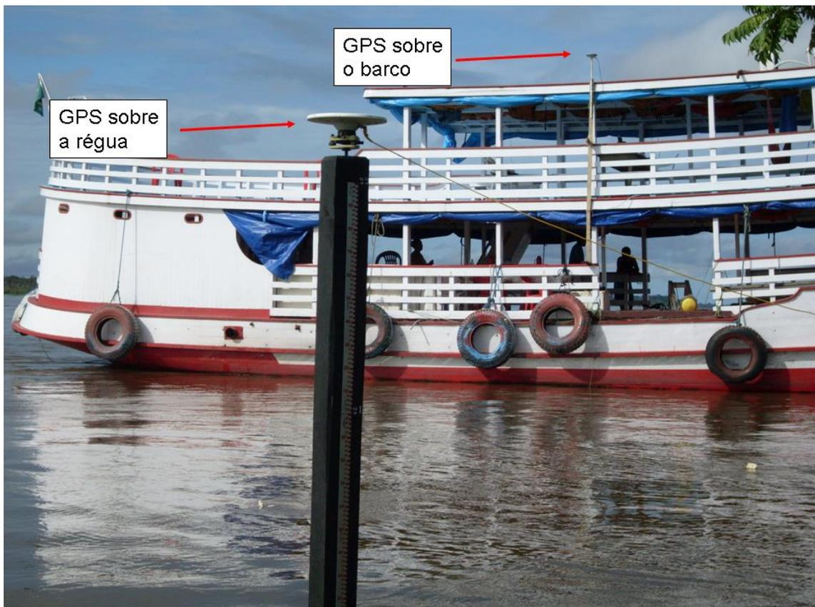
Figura 5.4 - Exemplo das estações utilizadas em dupla diferença para obtenção da diferença de altura entre a antena do receptor GPS do barco e a superfície da água.
