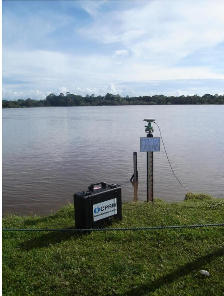
Figura 5.1 - Ocupação de um lance de régua por receptor GPS para obtenção de altitude do zero da estação fluviométrica de Porto União (rio Amazonas).
