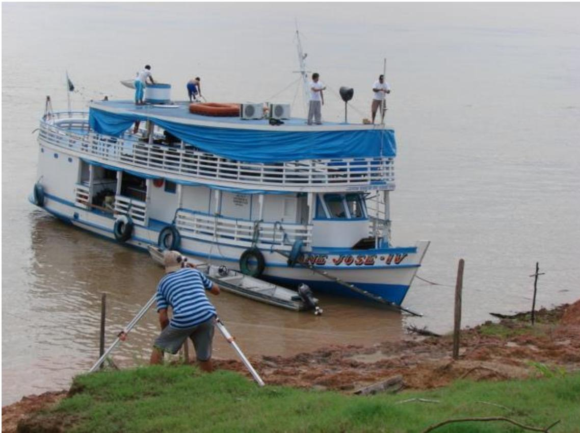
Figura 5.5 - Exemplo de nivelamento geométrico das alturas da antena do barco.
