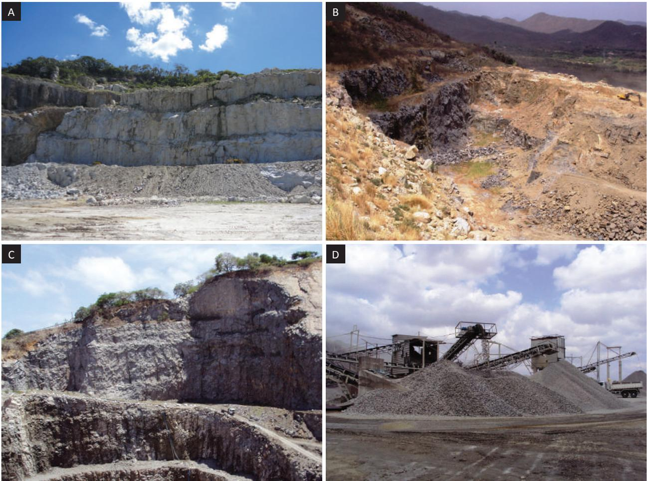
Foto 4.10 – Frentes de lavra para produção brita (a); frente de lavra de gnaise com bancadas de até 15 m de altura (b); frente de lavra de fonólito com bancadas de aproximadamente 20 m de altura (c); sistema de britagem com material separado por granulometria (d).
