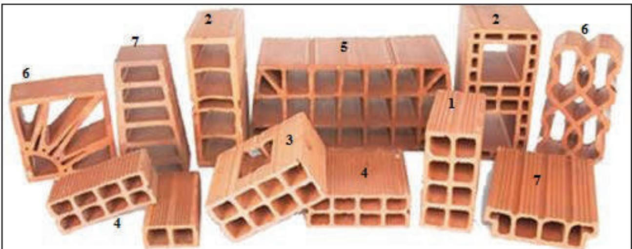
Figura 4.2 – Tipos de tijolos e blocos encontrados com maior frequência. Fonte: Grupo Tavares (Tipos de blocos: 1 Vedação, 2 Estrutural, 3 Elétrico e Hidráulico, 4 Bandinhas, 5 Lajota, 6 Combogó, 7 Produto especial).
