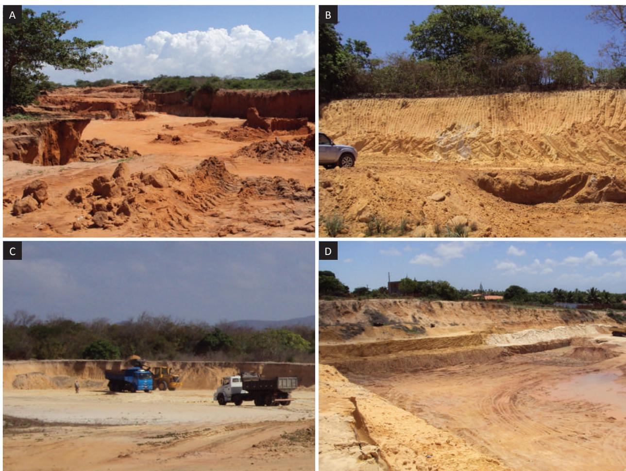
Foto 4.3 – Areia de coloração avermelhada e granulação fina (a); nível de arenito fino a conglomerático, intemperizado, abaixo da camada de areia vermelha (b); extração e carregamento com pá mecânica, formando bancadas de até 6 m de altura e transporte com caçambas basculantes (c); extração de grande porte subdividida em três níveis de bancadas (d).
