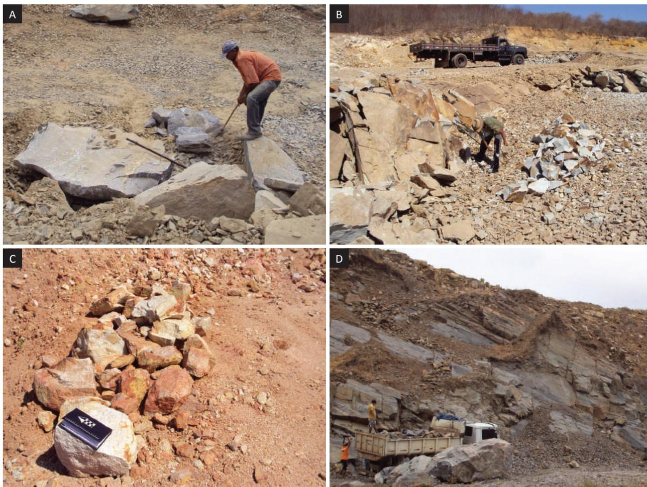
Foto 4.18 – Extração de pedra de talhe em migmatitos a partir de desmonte por fogacho, onde blocos da ordem de 1 m são marroados e retrabalhados manualmente (a); extração de pedra de talhe em traquito, sem utilização de explosivos, apenas aproveitando faturamento da rocha (b); lavra rudimentar de quartzito utilizado como alicerce (c); lavra abandonada com atividade clandestina para a retirada de fragmentos de gnaiss (d).
