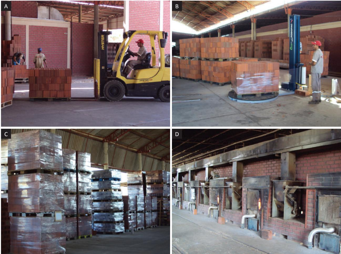
Foto 4.7 – Processo industrial automatizado: observa-se organização de tijolos em “palets” (a) e (b); pátio de estocagem (c); fornos automáticos (d).
