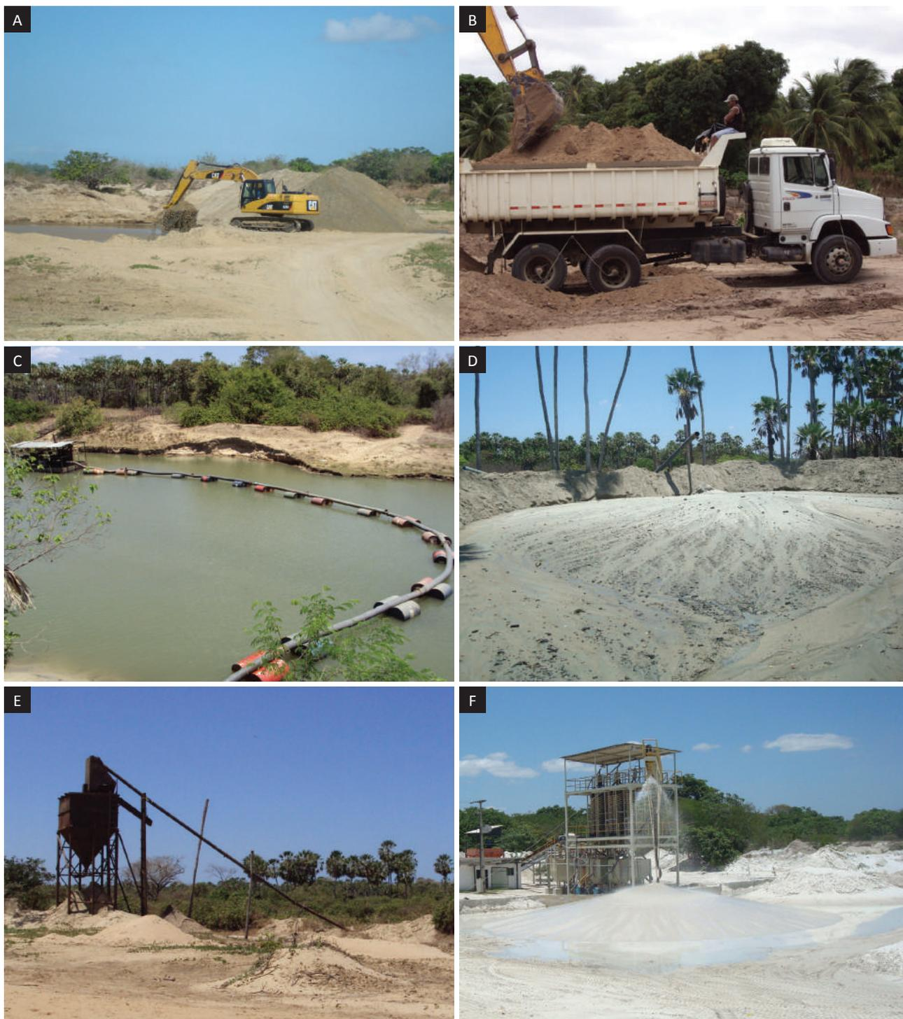
Foto 4.2 – Desmonte mecânico em planície de inundação (a); transporte do material diretamente da cava com pás carregadeiras e caminhões basculantes (b); extração de areia por dragagem em leito ativo de rio (c); tubo condutor da areia na forma de polpa (d); silos de classificação e estocagem (e); e beneficiamento de areia por hidrociclones para fins industriais (f).
