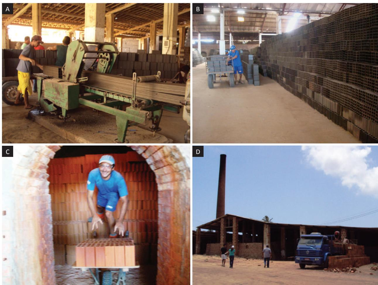
Foto 4.6 – Processo industrial rudimentar: confecção do tijolo (a); pátio de secagem (b); retirada do tijolo do forno, após queima (c); carregamento de caminhão para expedição (d).
