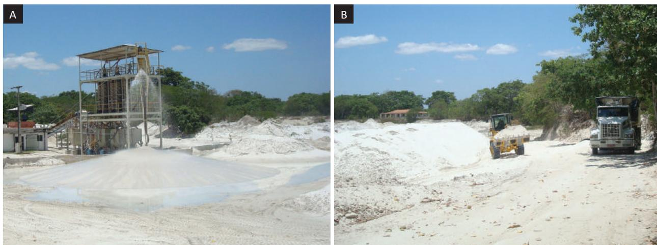
Foto 4.4 – Beneficiamento de areia por hidrociclones para fins industriais (a); e após lavagem, carregamento e transporte do minério (b).
