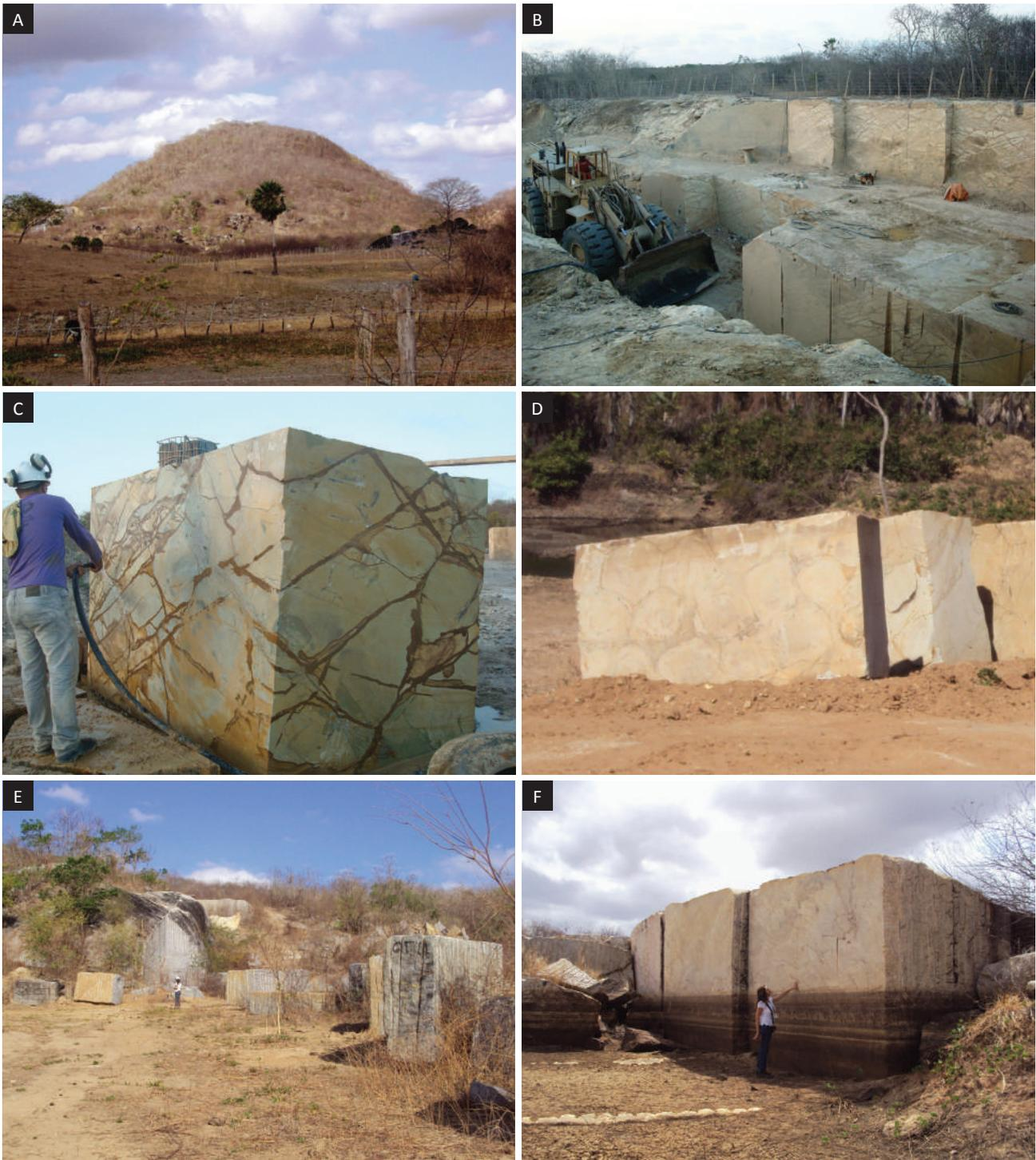
Foto 4.13 – Exemplo de elevação de pequena altitude de granito para rocha ornamental (a); lavra de traquito em atividade (b); rede de fraturas em traquito (c); aspecto do traquito que lembra o casco de uma tartaruga (d); frente de lavra paralisada de monzogranito cinza (e); frente de lavra abandonada de leucogranito com granada (f).
