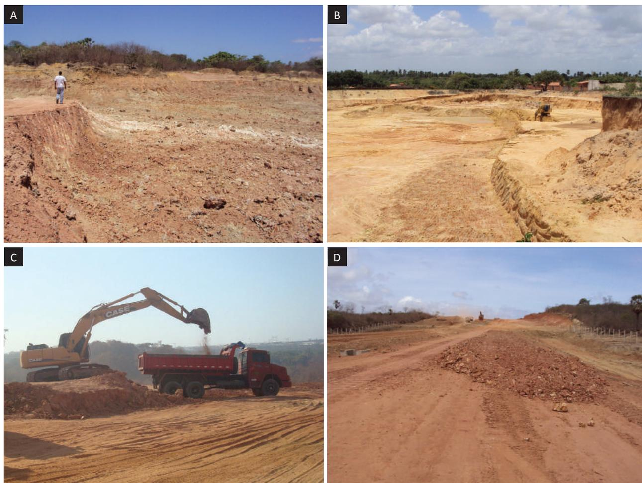
Figura 4.19 – Extração de material de empréstimo resultante da intemperização *in situ* de gnaisses do embasamento cristalino (a); extensa área de exploração de material de empréstimo, resultante da alteração *in situ* de sedimentos do Grupo Barreiras (b); desmonte do minério com máquina escavadeira e transporte de material em caminhões basculantes (c); saibro utilizado em pavimentação de estradas (d).
