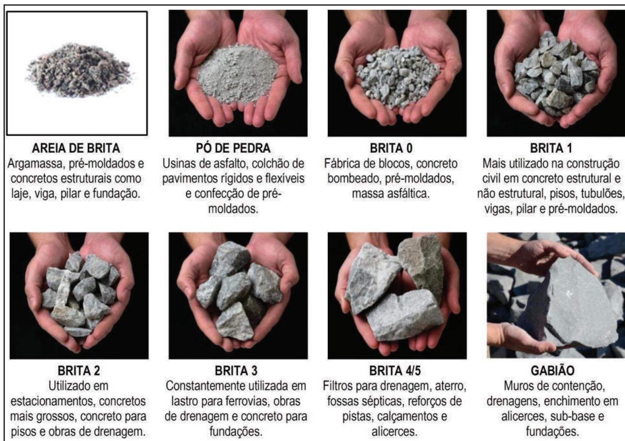
Figura 4.5 – Produtos gerados no processo de britagem e suas principais aplicações em função da granulometria (modificado de MinerMAC, 2014).
