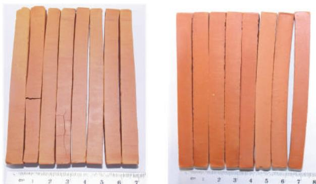
Foto 4.9 – Aparência de trincas e empenamentos em amostras de corpo de prova sinterizadas a 950 °C.
