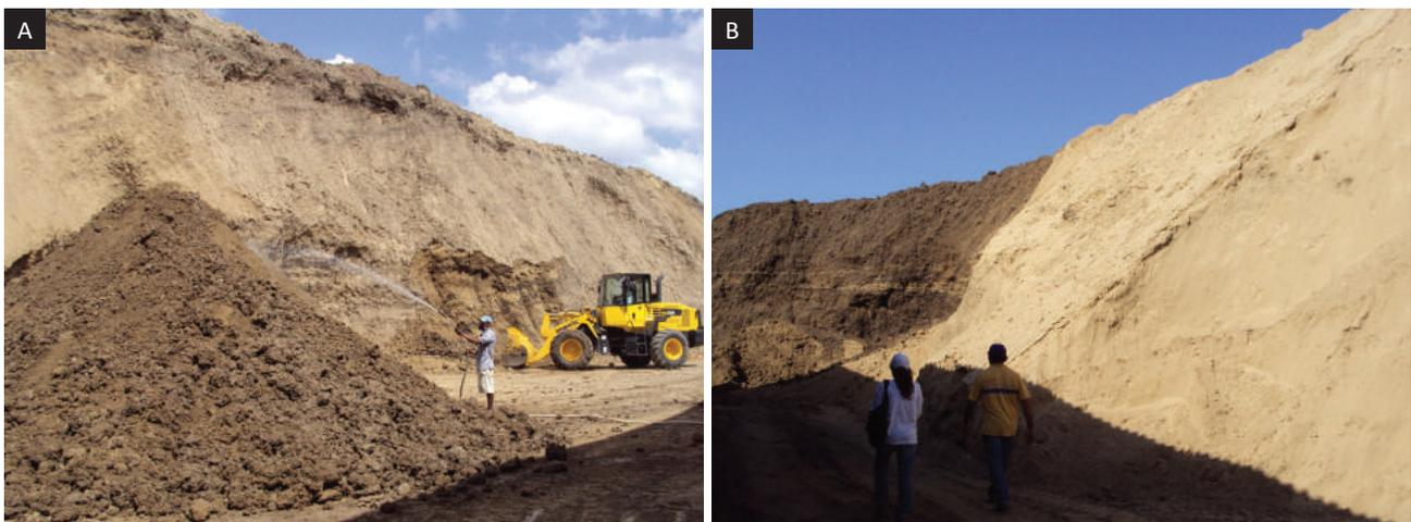
Foto 4.8 – Preparação da massa cerâmica, que consta de umidificação e homogeneização da matéria-prima (a); diferença de coloração entre as argilas forte mais escura e fraca mais clara (b).
