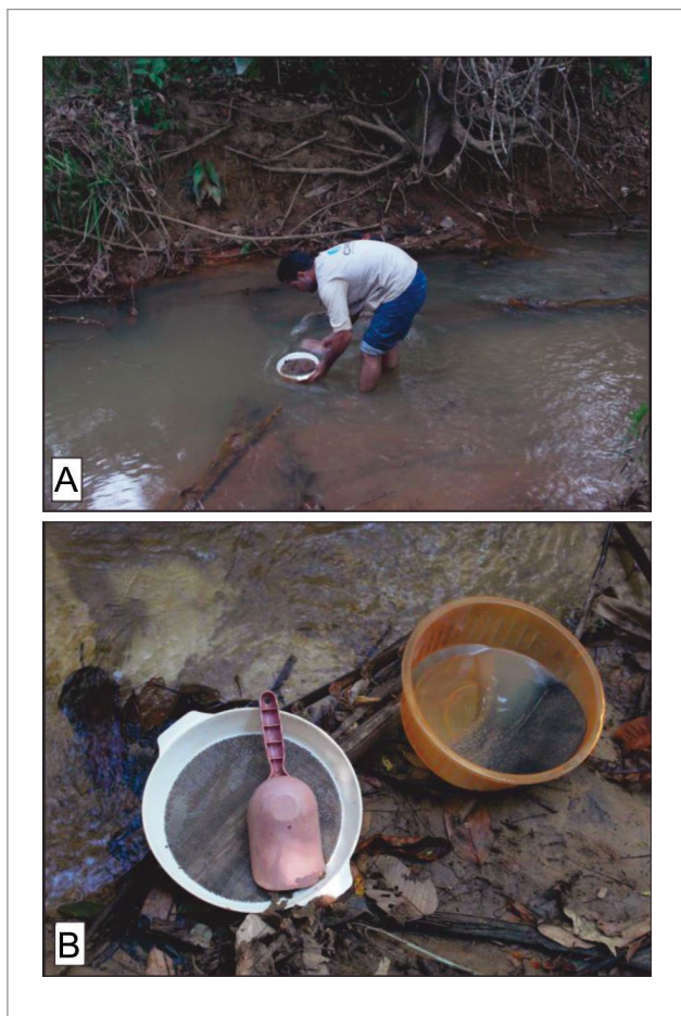
Figura 5.2 - (A) Procedimento de coleta de sedimento de corrente em leito ativo. (B) Material utilizado no procedimento de coleta de sedimento de corrente.
