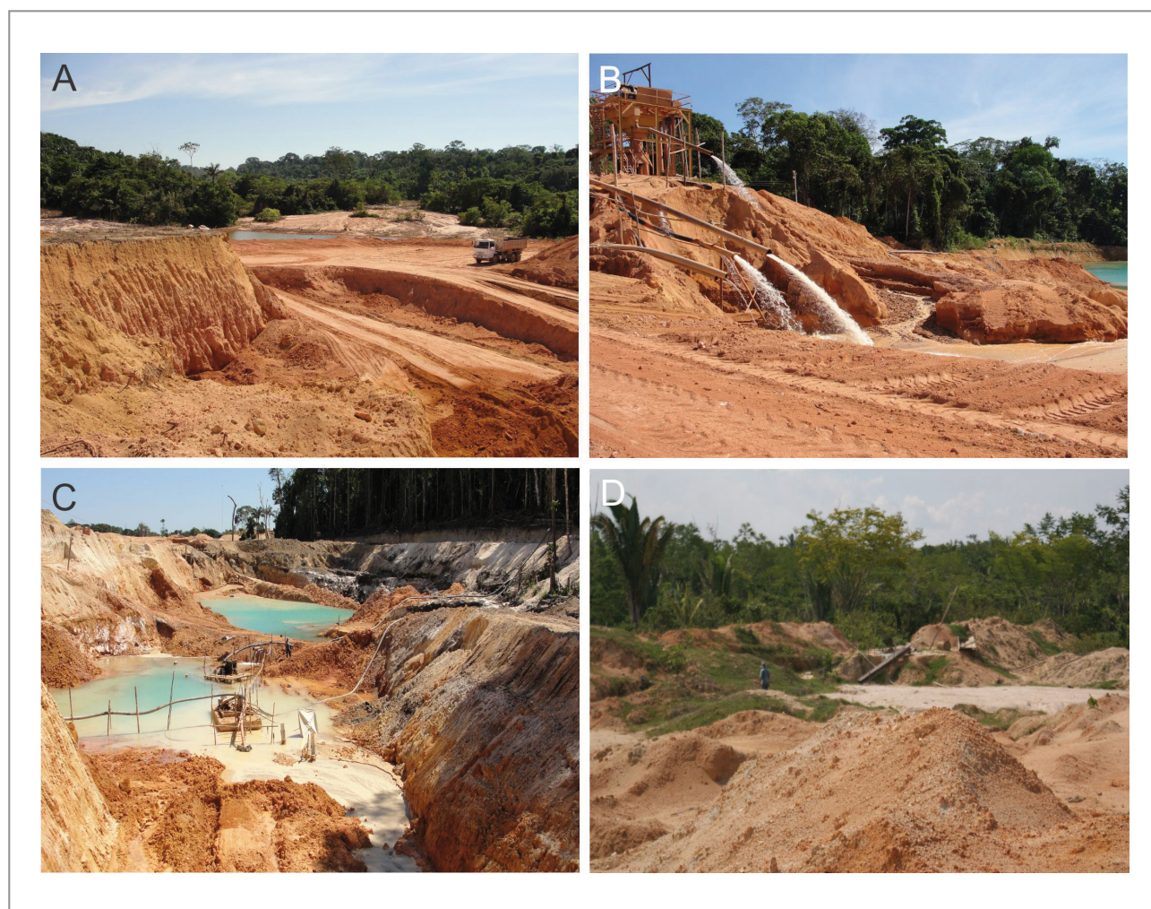
Figura 6.1 - A e B) Mostram depósitos secundários de estanho, do tipo placer, onde é feito desmanche a jato dos barrancos; C) Depósito secundário de columbita. Um das poucas onde o produto principal é a columbita; D) depósito secundário de topázio dentro do Maciço Masangana.
