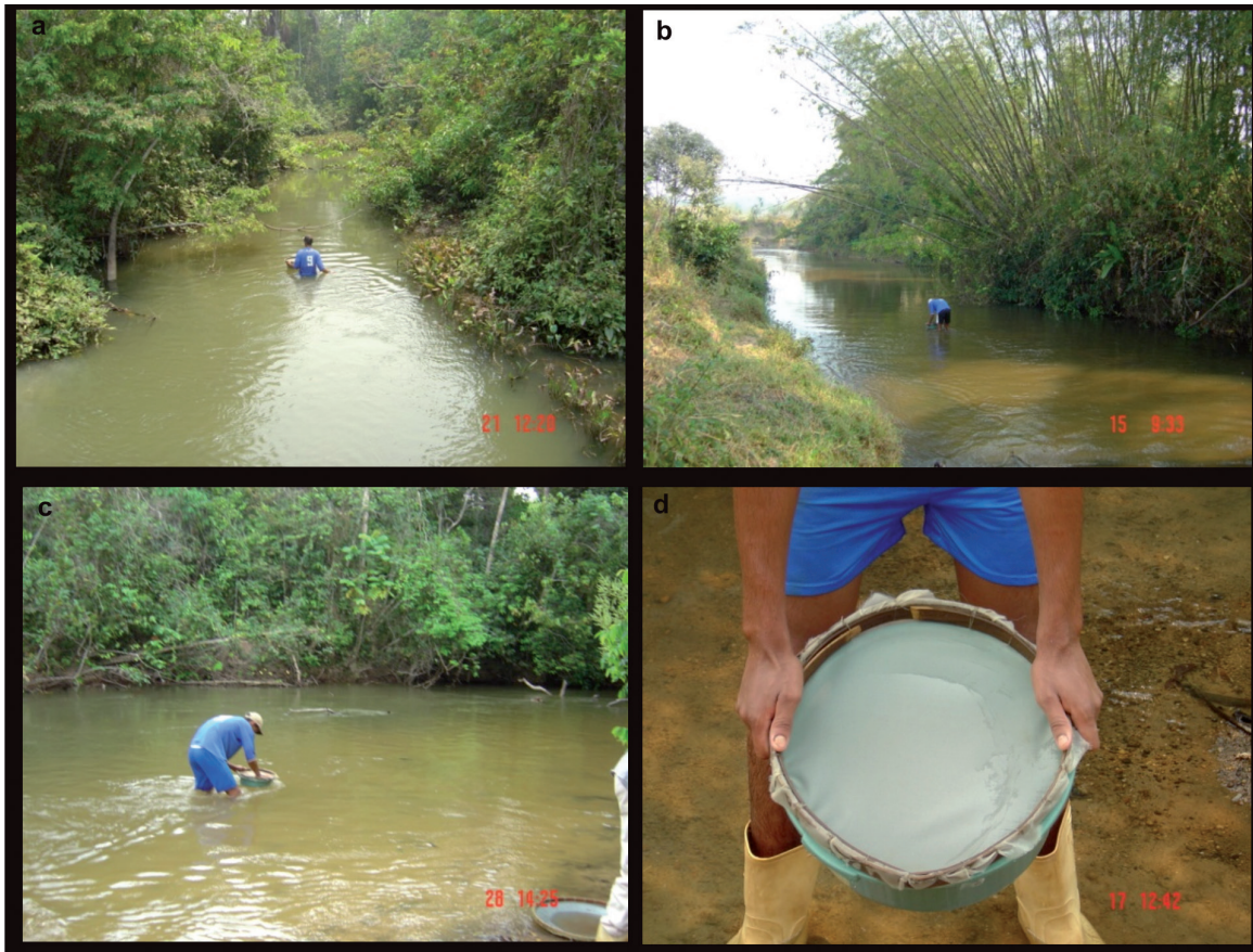
Figura 68 - (a e b) Coleta dos sedimentos de corrente no leito ativo da drenagem; (c) Coleta dos sedimentos de corrente com peneiramento simultâneo; (d) Peneira de malha plástica com abertura de 60 # (0,250 mm).
