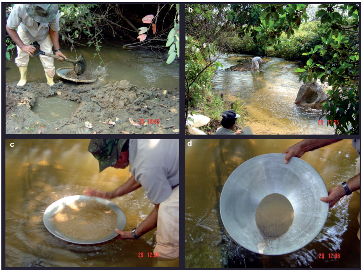
Figura 69 - (a, b) Coleta de sedimento aluvionar com auxílio de pá, em locais de concentração natural; (c) Bateamento parcial de 10 litros de sedimento aluvionar; (d) Concentração do material.
