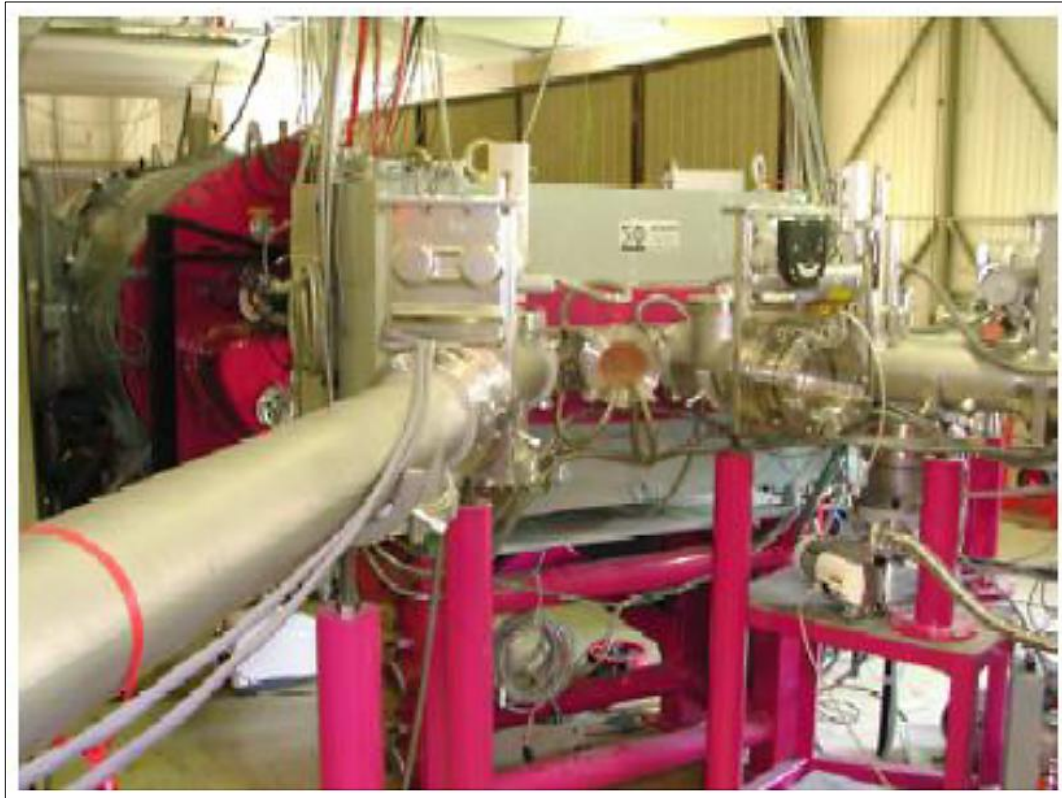
Figura 6.9 - Acelerador ARAMIS que simula ação de raios ionizantes (Orsay, França).
