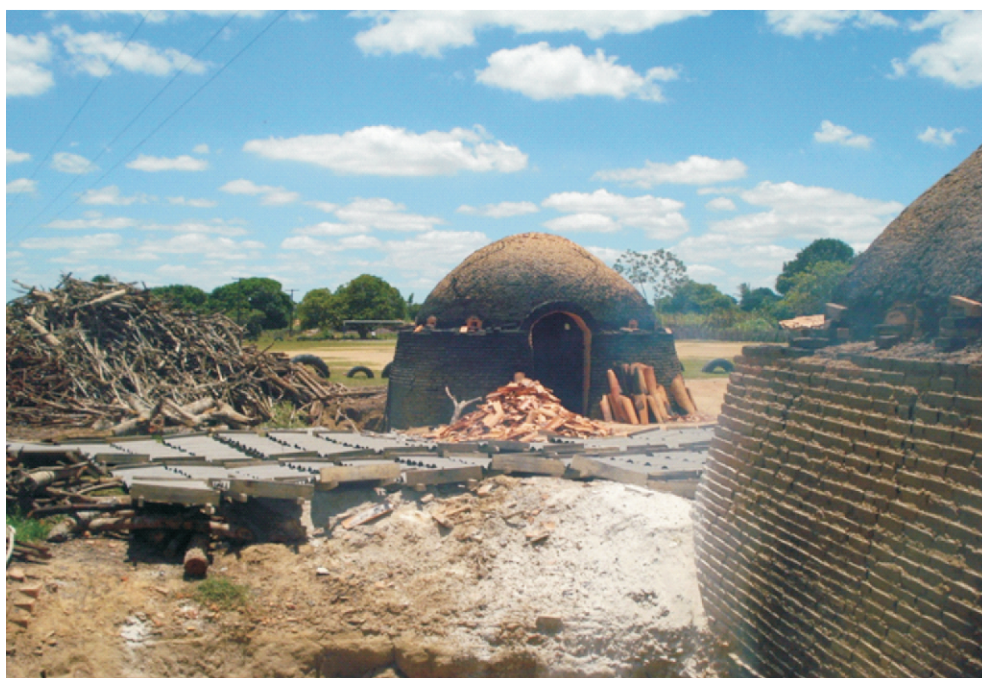
Foto 7.25 - Forno de tijolos a lenha empregado no Polo Oleiro do Erel. Povoadado de Sapé, município de Nossa Senhora das Dores.
