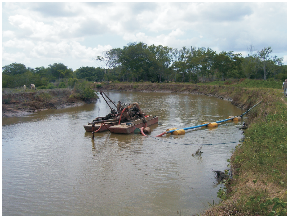
Foto 5.1 - Extração de areia através de draga rudimentar no rio Vaza-Barris. Areal do Mosquito, município de Itaporanga d'Ajuda.
