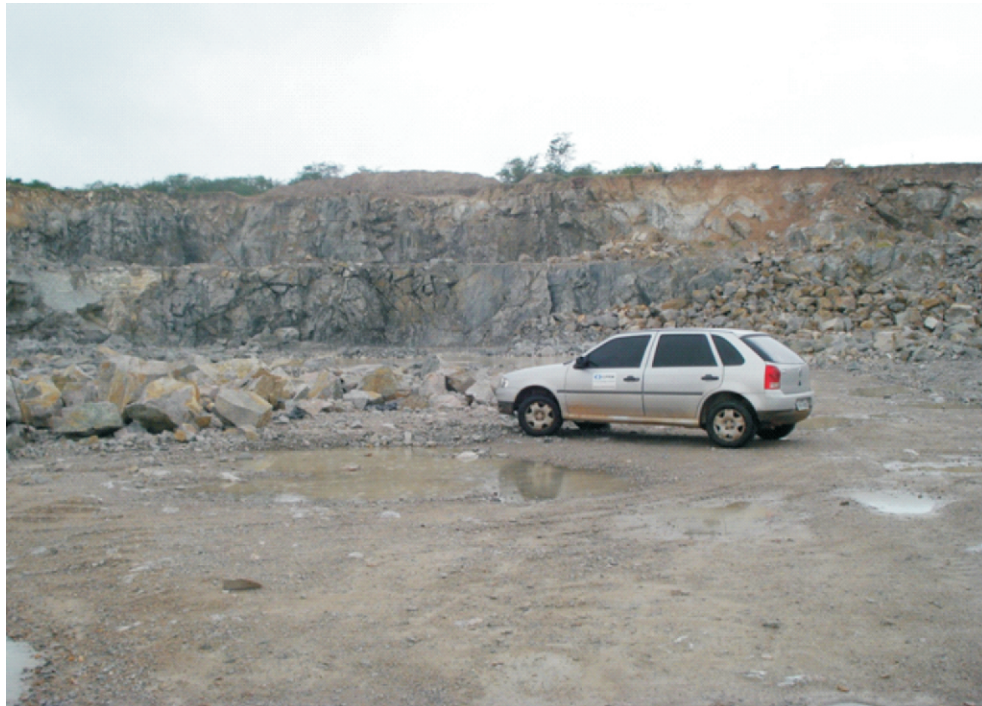
Foto 8.3 - Vista parcial da cava da Pedreira Anhanguera, com bancadas de 9 a 10 m de altura. Município de Itabaiana.
