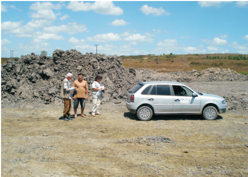
Foto 7.20 - Lavra de xistos intemperizados do Grupo Macururé, usados como "selão". Município de Propriá (amostra 45Arg).
