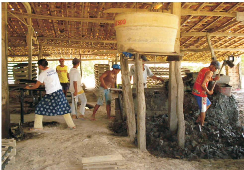
Foto 7.24 - Produção rudimentar de telha, com carregamento de barro da extrusora e transporte manual das peças. Polo Oleiro do Erel.
