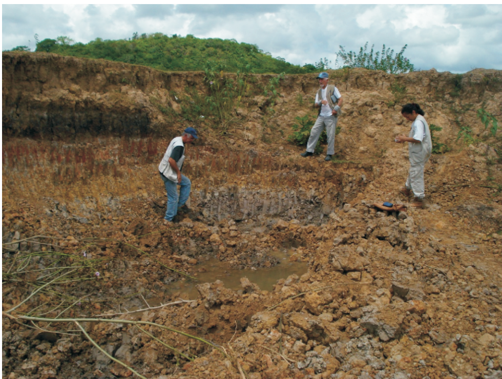
Foto 7.21 - Cobertura areno-argilosa sobre camada de argila plástica de várzea, lavradas conjuntamente. Terreno da Cerâmica Fênix, município de Santana do São Francisco (amostras 104Arg e 105Arg).
