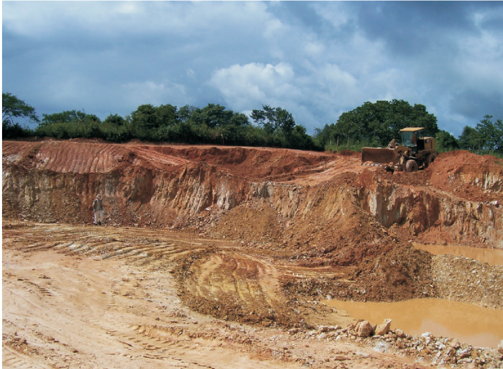
Foto 7.5 - Lavra de filito intemperizado (“selão”) da Formação Frei Paulo. Depósito Pinhão, município de Ribeirópolis (amostra 14Arg).
