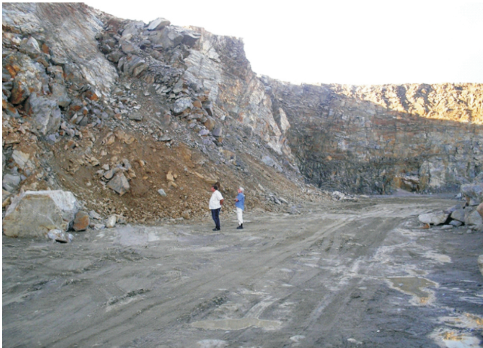
Foto 8.4 - Cava principal da Pedreira Dinâmica, com bancada de 16 a 20 m de altura. Município de Itabaiana.
