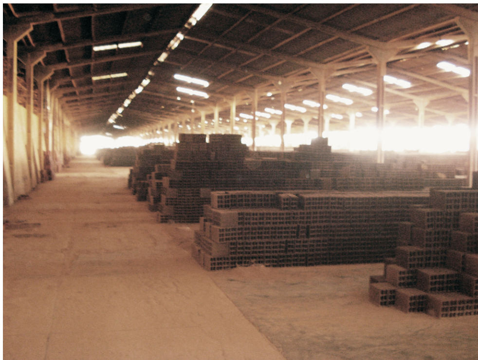
Foto 7.11 - Galpão de secagem de blocos da Cerâmica São José, município de Itabaianinha.
