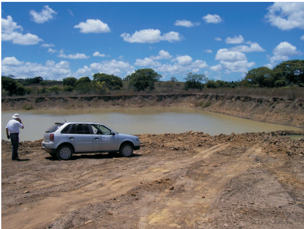
Foto 7.15 - Lavra de argila de várzea em tanques já delimitados. Fazenda Feiticeira, município de Muribeca - amostras 39Arg (a) e 39Arg(b).
