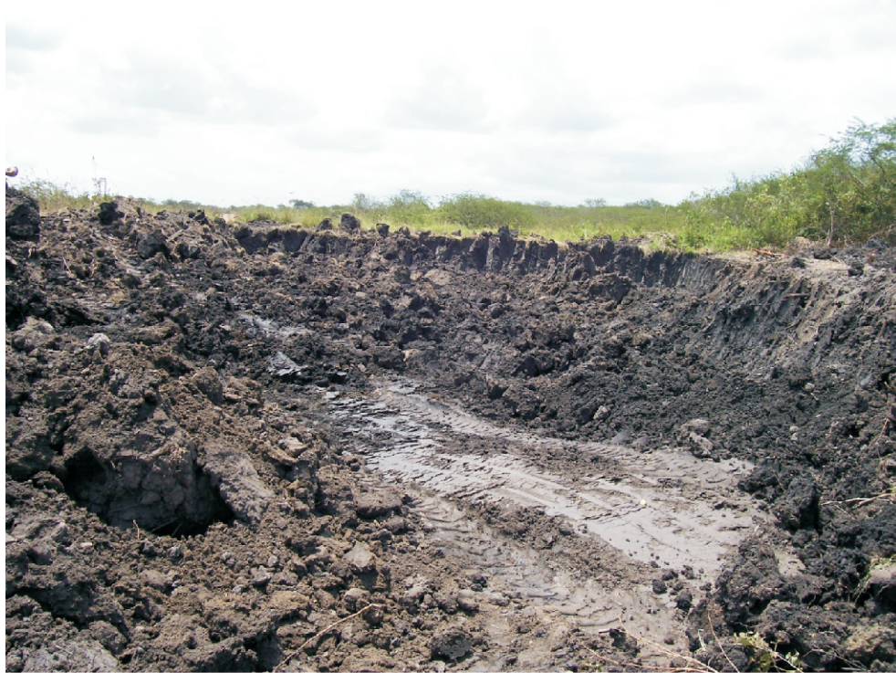
Foto 7.3 - Lavra de argila em várzea rasa. Próxima do povoado de Terra Vermelha, município de Macambira, região de Itabaiana.
