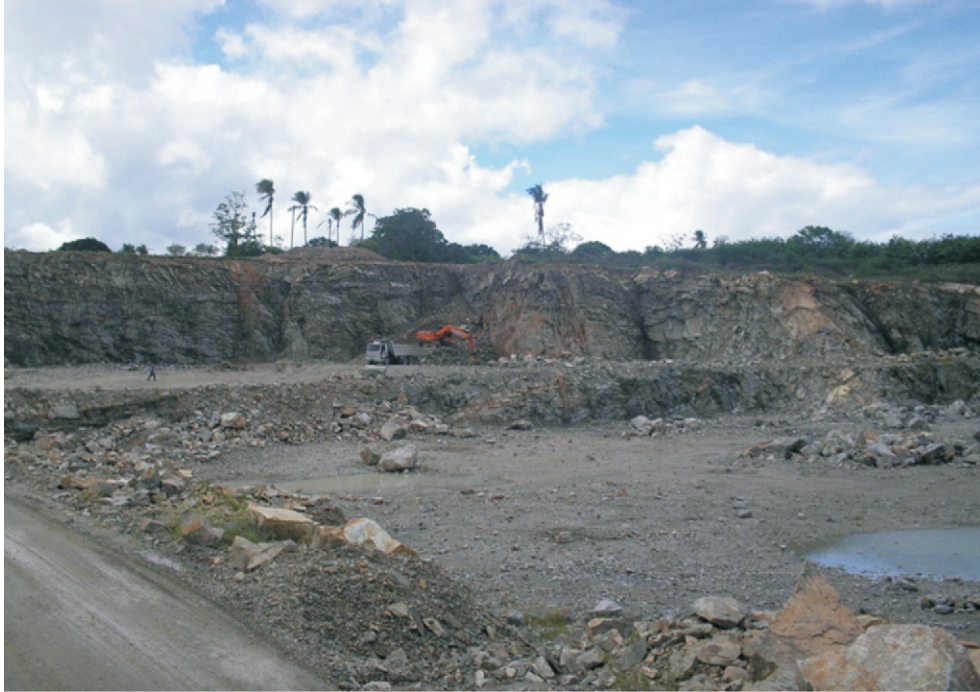
Foto 8.1 - Aspecto geral da cava da Pedreira Rio das Pedras, mostrando bancada com 18 m de altura. Município de Itabaiana.
