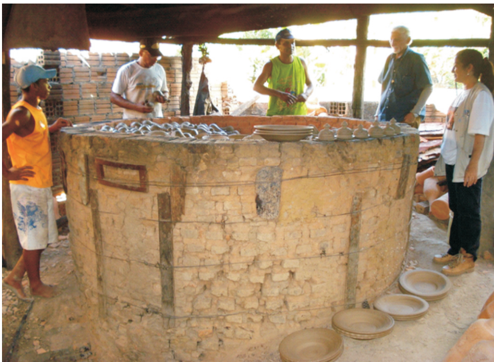
Foto 7.27 - Carregamento de peças de barro para queima em forno de barro. Cidade de Santana do São Francisco.
