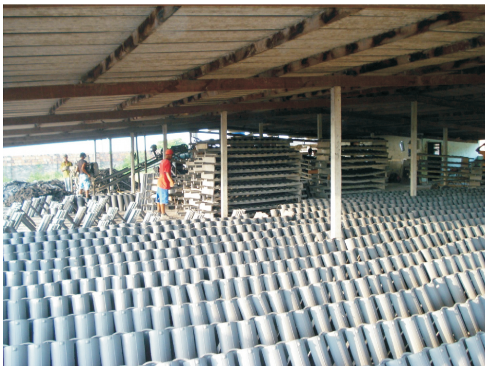
Foto 7.12 – Processo de produção de telha colonial no município de Itabaianinha.
