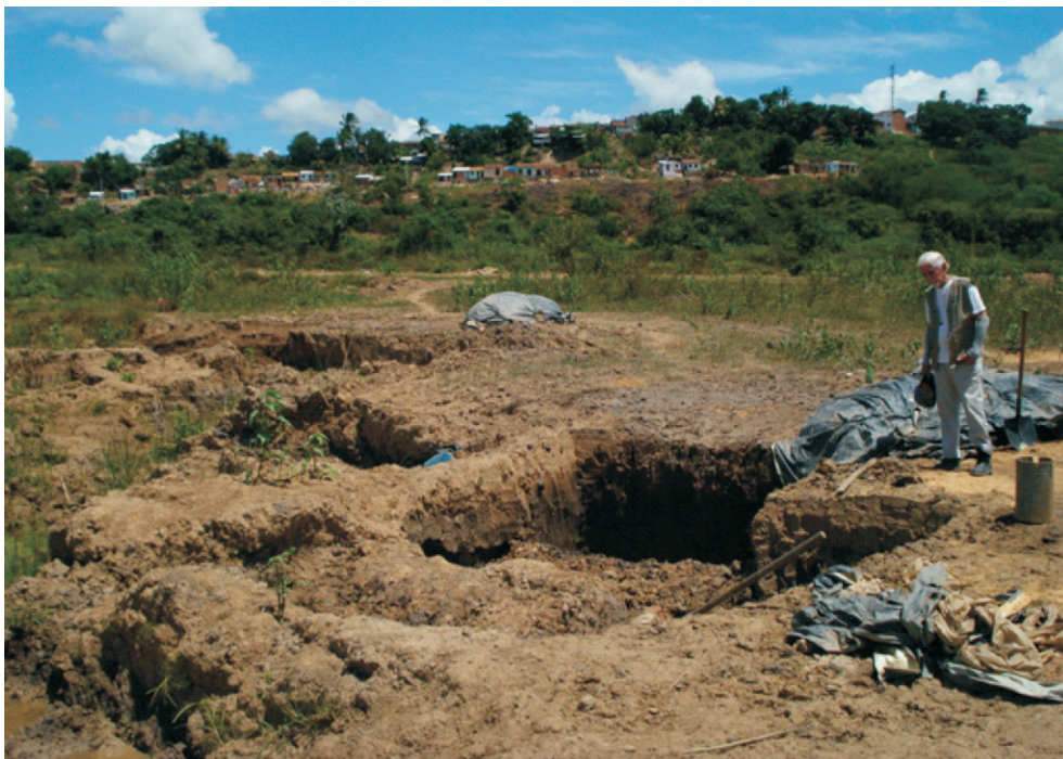
Foto 7.26 - Extração manual de argila selecionada de várzea, para artesanato. Depósito de Carrapicho, na periferia da cidade de Santana do São Francisco (amostra 108Arg).
