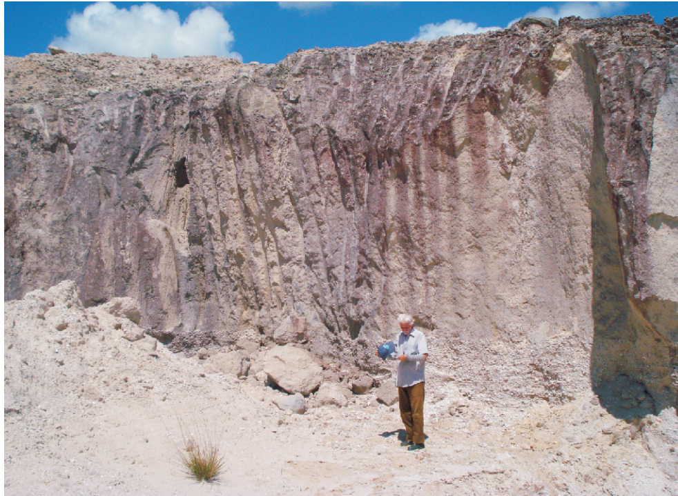
Foto 6.7 - Frente de lavra da empresa Pizarreira e Areal Bela Vista mostrando sedimentos areno-argilosos sobrepostos a areias cascalhosas, município de Estância.
