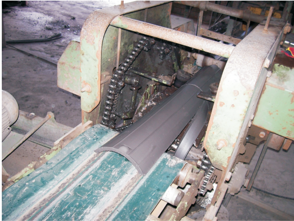
Foto 7.13 - Telha colonial extrudada. Município de Itabaianinha.
