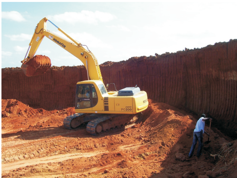
Foto 7.9 - Lavra de gnaiss intemperizado (“selão”), próxima do povoado Jardim, município de Itabaianinha (amostras 34Arg e 56Arg).
