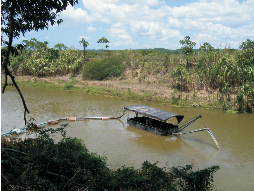
Foto 5.3 - Dragagem de areia do leito ativo do rio Vaza-Barris. Areal da Fazenda Belém, município de Itaporanga d'Ajuda.
