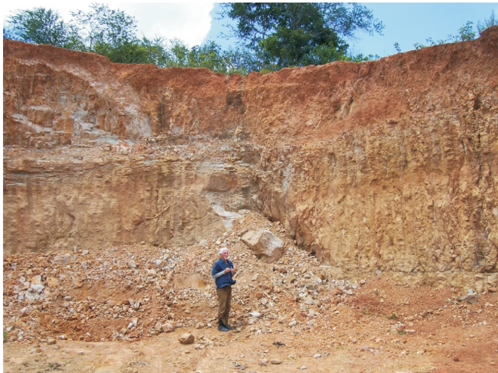
Foto 7.17 - Lavra de siltitos argilosos, micáceos, da Formação Riachuelo, usados como fundente. Fazenda Alecrim, município de Siriri (amostra 31Arg).
