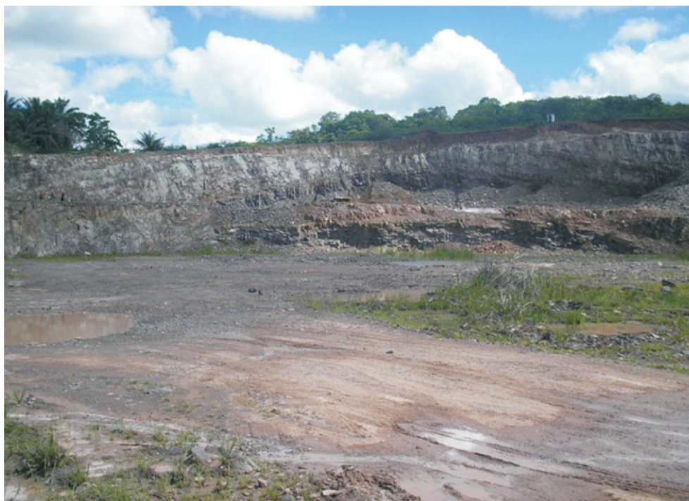
Foto 8.5 - Frente de lavra de uma cava da Pedreira MM Material de Construção, com bancadas com 6 a 12 m de altura. Município de Itaporanga d'Ajuda.
