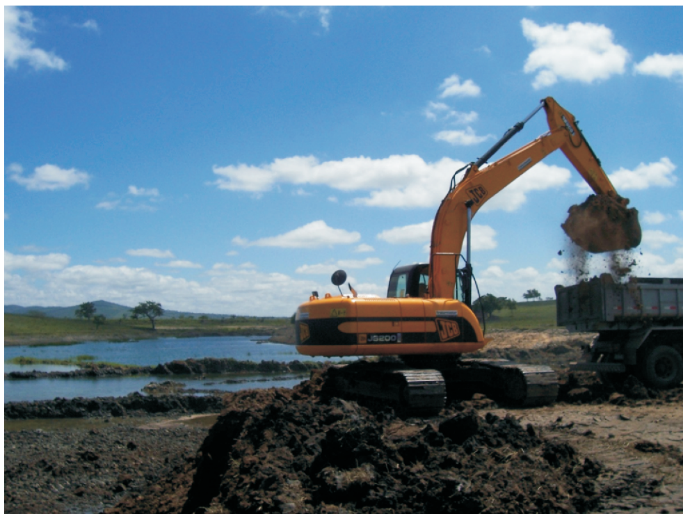
Foto 7.8 - Lavra de argila em várzea profunda. Fazenda Diamante, município de Itabaianinha (amostra 55Arg).
