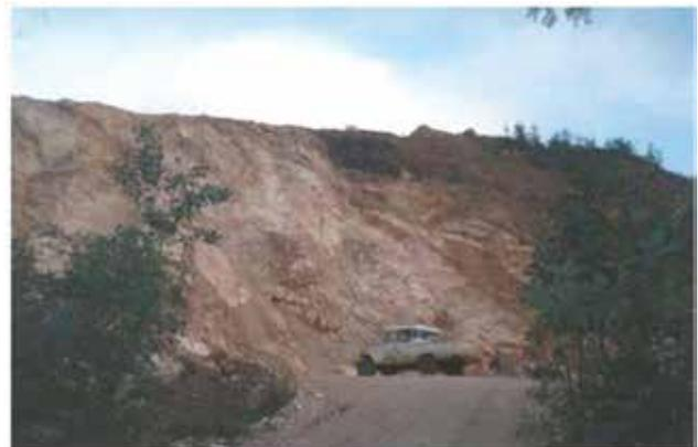
Foto 4.5 – Uma das frentes de lavra da MIBASA, na localidade de Serra do Boqueirão (40 md), onde o mármore dolomítico para corretivo de solo é desmontado e transportado para as instalações de beneficiamento, situadas a poucos metros. Belo Monte - AL.
