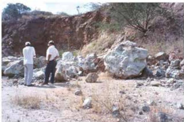
Foto 4.7 – Blocos de serpentinitos acumulados no pátio de uma antiga produtora de asbesto antofílitico. O serpentinito, decorrente da lavra seletiva atual, é destinado à produção do MB-4, usado no melhoramento nutricional dos solos. Mina Campestre-Jazida Luiz Vieira, da MIBASA.
