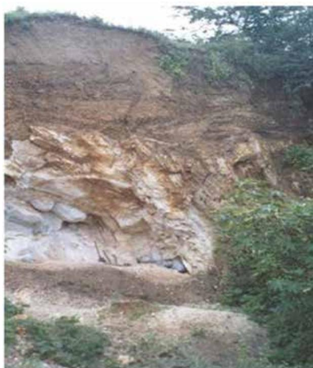
Foto 4.6 – Uma das várias frentes de lavra da Mineração Coruripe da Cal (md 54). As camadas de mármore dolomítico são alcançadas por escavações, mostrando a cobertura de solo formado a expensas das rochas carbonatadas. As camadas acham-se dobradas, apresentando mergulho forte, com orientação local de N55ºE, alinhadas com o trend regional.
