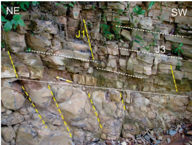
Figura 5.16 – Afloramento ilustrando a relação entre as juntas J3, J1 e o acamamento sedimentar (S0) (UTM 378386; 8333888)
