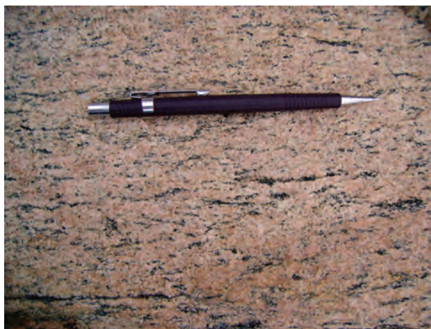
Foto 3.120 – Mostra foliação/bandamento marcado pelo estiramento das fases félsicas e por leitões/bandas descontínuas ricas em biotita. Fácies augen ortognaisse granodiorítico a granítico da Suíte Intrusiva Rocinha – NP1 \gamma rc (Afloramento SF-182).
