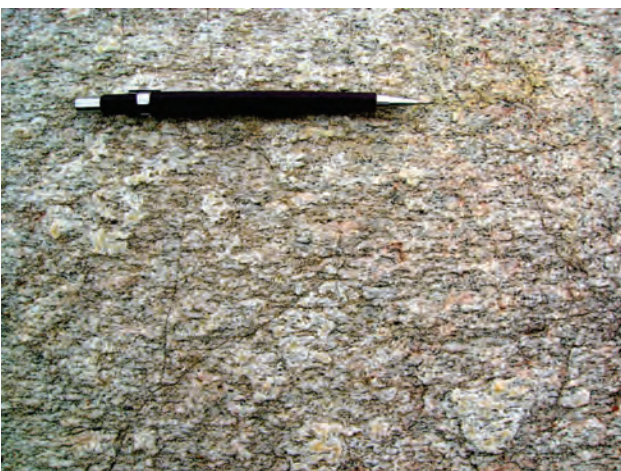
Foto 3.33 – Metamonzogranito equigranular médio, com porfiroclastos estirados de alcalifeldspato. Ortognaise Lobo – NP1γI (Afloramento FL-146).
