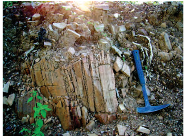
Foto 3.51 – Quartzito equigranular fino bandado, marcado pela alternância de níveis micáceos e quartzito granoblástico fino. Complexo Lagoa das Contendas, litofácies quartzito – NP1cq (Afloramento SF-158A).
