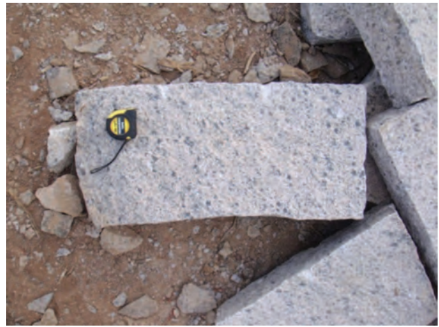
Foto 5.9 – Pedra de meio fio, notar a coloração e textura do material utilizado. Ponto MM-19.
