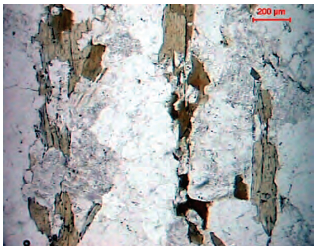
Foto 3.23 – Fotomicrografia de biotita gnaisse granodiorítico, exibindo cristais lamelares e orientados de biotitas (Bt), marcando a foliação. Nicóis //. Ortognaisse Logradouro – MP3γlg (Afloramento FL-523).
