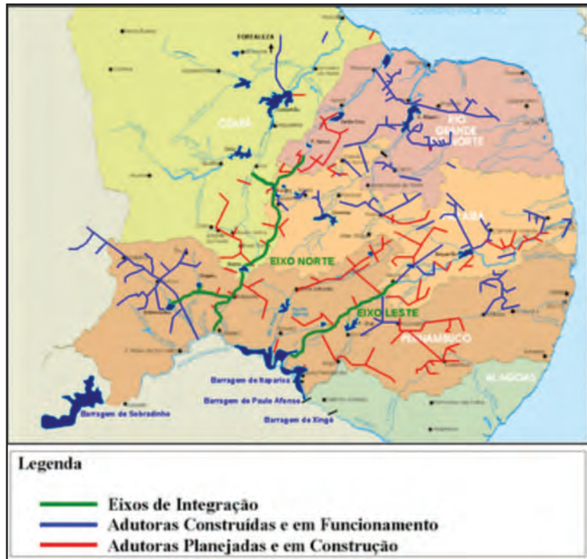
Figura 1.4 – Mapa com os trechos dos eixos norte e leste do canal do “Projeto de integração do Rio São Francisco com as bacias hidrográficas do nordeste setentrional” e as suas adutoras. (Fonte: Ministério da Integração in www.coletiva.org ).
