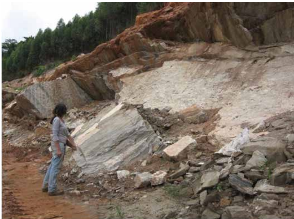
Figura 5.58 - pedreira para extração de rocha ornamental sob o granitóide da Suíte Galiléia (UTM – 216287/7774176)
