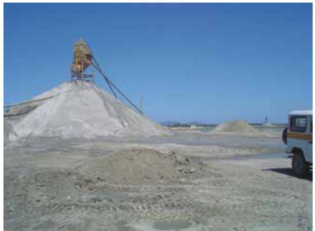
Figura 7.5 – Separação granulométrica de areia, extração em cava, município de Cabo Frio
