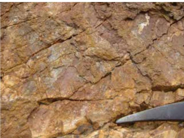
Figura 4.40 – Plano estriado na Falha do Bico Preto, normal com componente dextral
