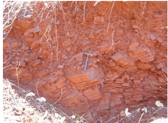
Figura 2.16 - Formação ferrífera bandada em trincheira na área de Saco Seco, na região da mina de Saquinho em Cruzeta/RN. É possível observar o mergulho de baixo ângulo da camada de rocha e o limite com o colúvio.
