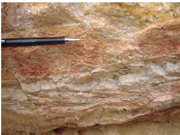
Figura 4.9 – Detalhe de quartzito com porções feldspáticas da litofácies de xisto da formação Água Clara (afloramento MB-076, pedreira nos arredores de Feital, Doutor Ulysses, PR). Fotografia: Mariane Brumatti, 2011.
