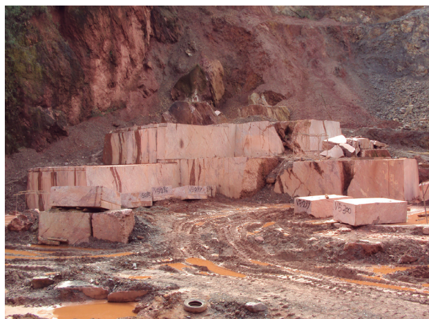
Figura 6.9 – Lavra a céu aberto de metacalcário (mármore) utilizado como rocha ornamental da formação Bairro dos Campos do grupo Itaiacoca (afloramento MB-048, mina da Aco Mineração Ltda., zona urbana de Doutor Ulysses, PR). Fotografia: Sérgio Wilians de Oliveira Rodrigues, 2010.
