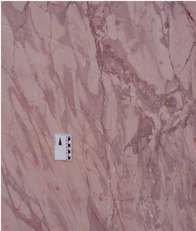
Figura 4.27 – Corte em pedra de metacalcário calcítico com estromatólitos da formação Bairro dos Campos (afloramento MB-48, pedra da Aco Mineração Ltda., zona urbana de Doutor Ulysses, PR). Fotografia: Sérgio Wilians de Oliveira Rodrigues, 2011.
