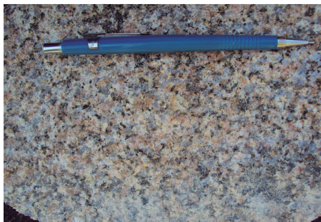
Figura 4.64 – Detalhe de biotita-monzogranito fanerítico grosso do granito Vila Branca da suíte granítica Cunhaporanga (afloramento MB-99, cerca de 3 km a noroeste de Doutor Ulysses, PR).
