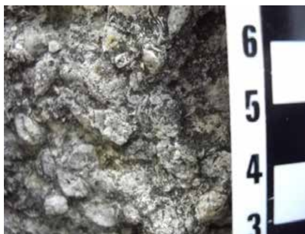
Foto 3.39 – Detalhe de amostra de mão do calcário bioclástico da Formação Romualdo. Afloramento no topo da Serra do Periquito.
