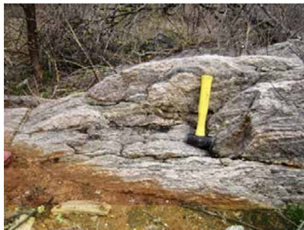
Foto 3.4 – Paragnaisse do Complexo Sertânia com bandamento gnáissico bem marcado (78°/320Az) (VH – 233; 610426, 9055088). O paragnaisse exhibe abundantes mobilizados quartzo-feldspáticos e pegmatíticos concordantes, caracterizando um fácies migmatítico estromático.
