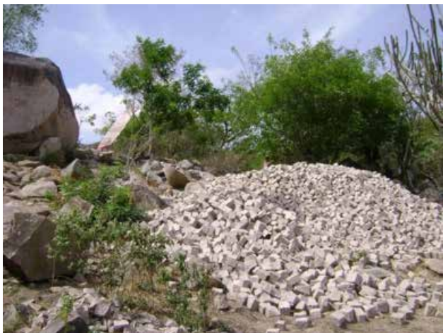
Foto 5.1 – Pedreira artesanal para confecção de paralelepípedos que são utilizados para pavimentação de estradas. Afloramento da Suite Intrusiva Itaporanga nas proximidades de Manari.
