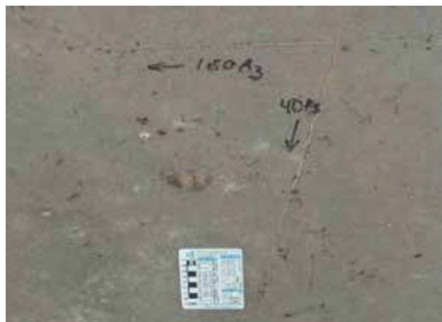
Foto 3.21 – VH-048. Bandas de deformação preenchida por sílica. Direções medidas: 160 Az e 40 Az.
