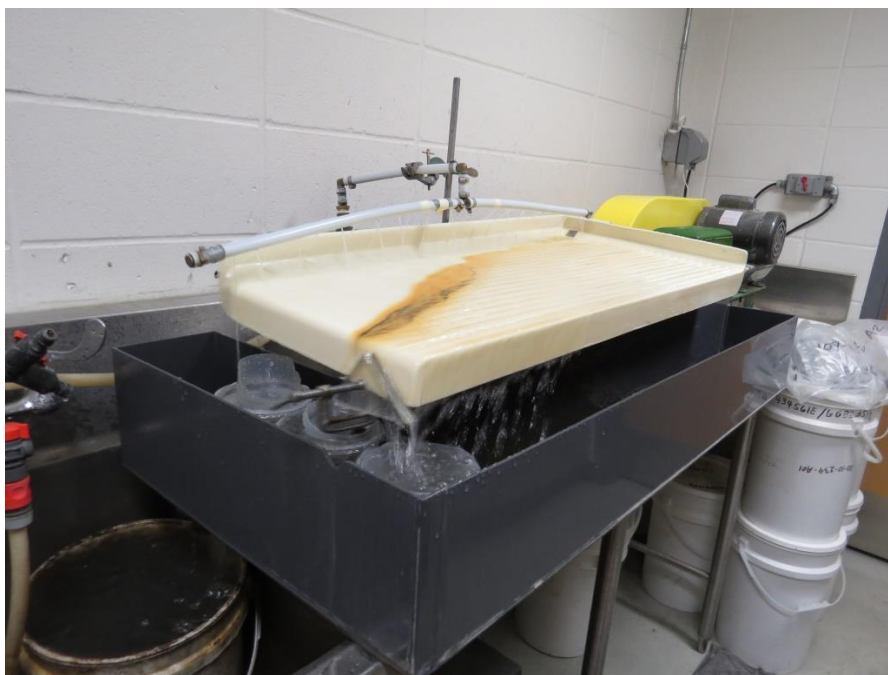
Figura 3. Mesa de Wilfley em funcionamento.
