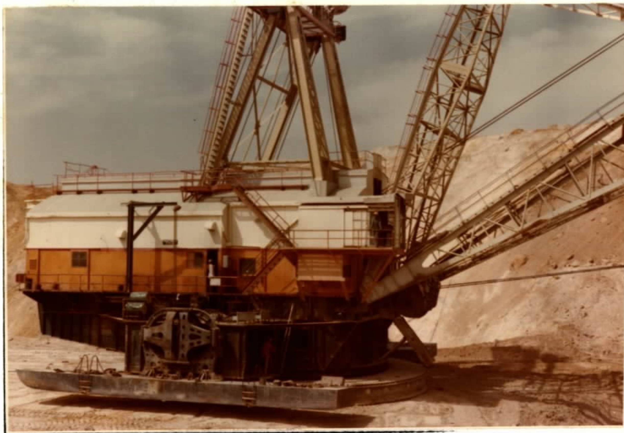
24 - Taiba - "Dragline" em operação de desmonte do estéril inferior.
