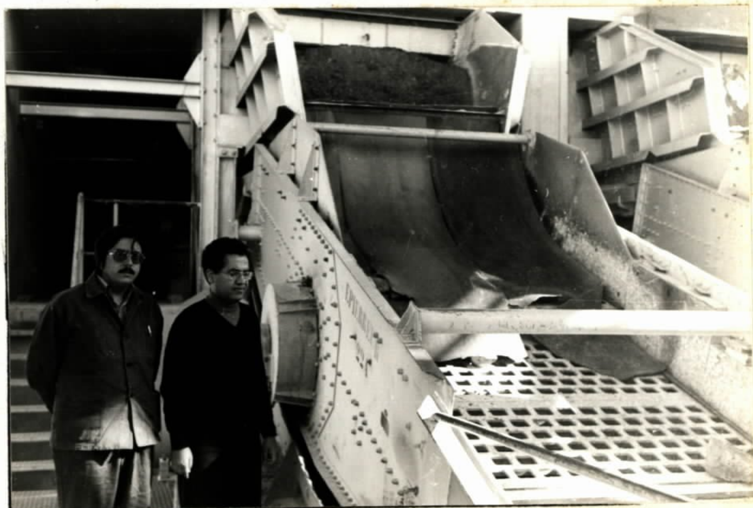
10 - Youssoufia - Instalação de Beneficiamento - Grelha de 90 mm.
