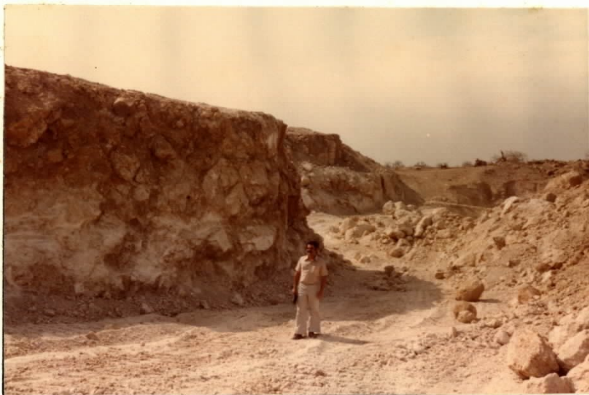
18 - Lam-Lam - Bancada de lavra do fosfato de alumínio, no tando-se na parte superior a formação de canga ferruginosa.
