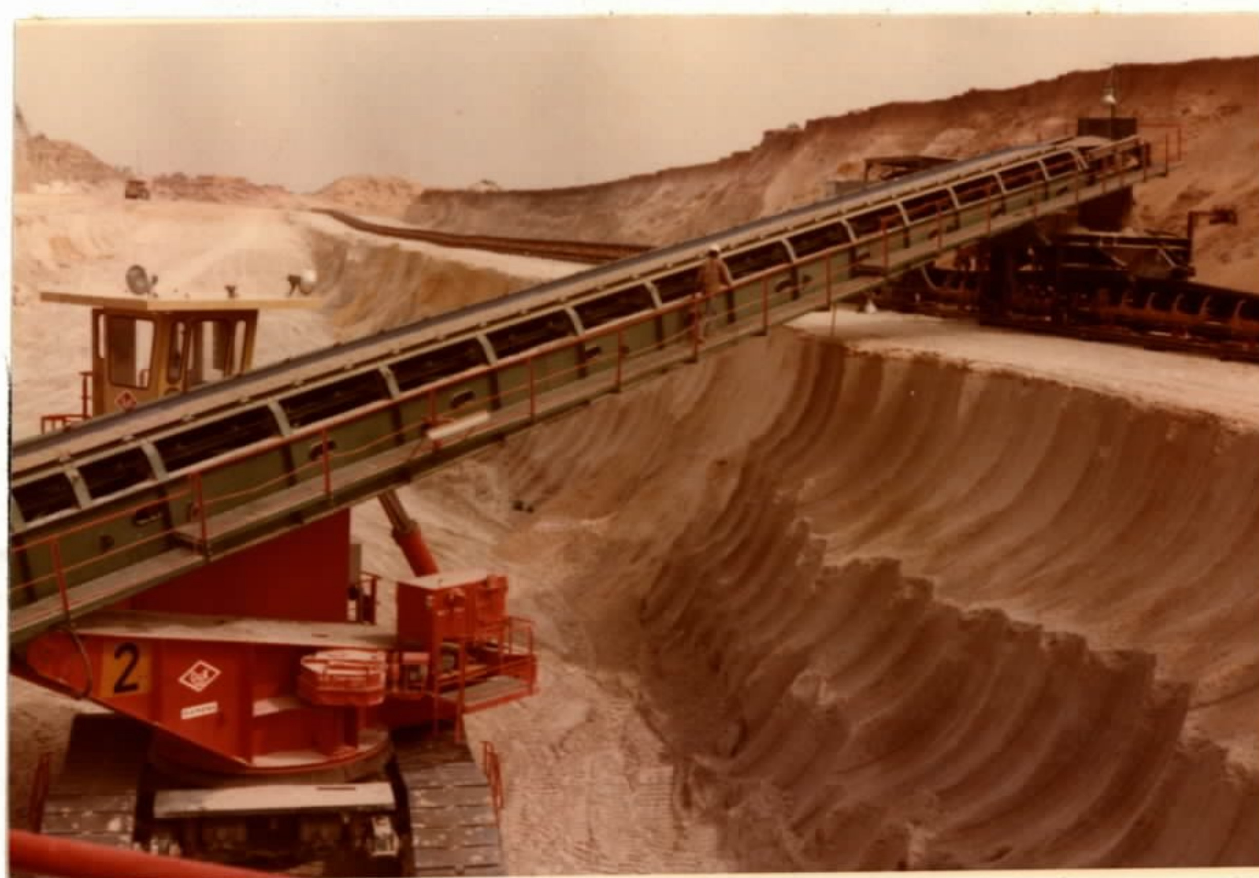
23 - Taiba - "Spreader" conduzindo a areaia desmontada às correias transportadoras.
