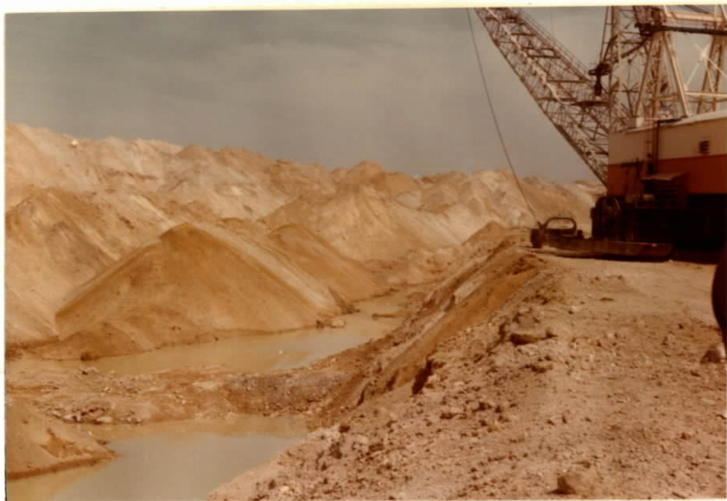
26 - Taiba - Vista da frente de lavra mostrando ao fundo a deposição do estéril nos locais já lavrados. O topo - da camada de minério coincide com o nível da água.
