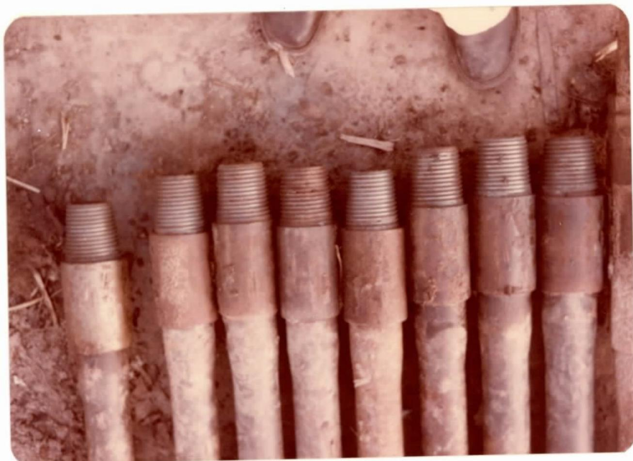
FOTO 23 - Drill Pipes de 2 7/8", 20 pés, com up set no "tool joint".
