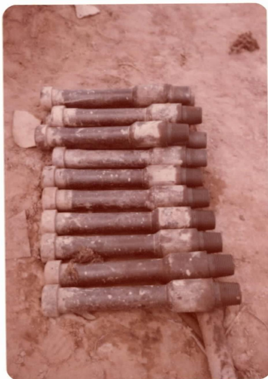
FOTO 1 - Subs "torpedo" usado para içamento de comandos, que não possuem encaixe para cunha.
