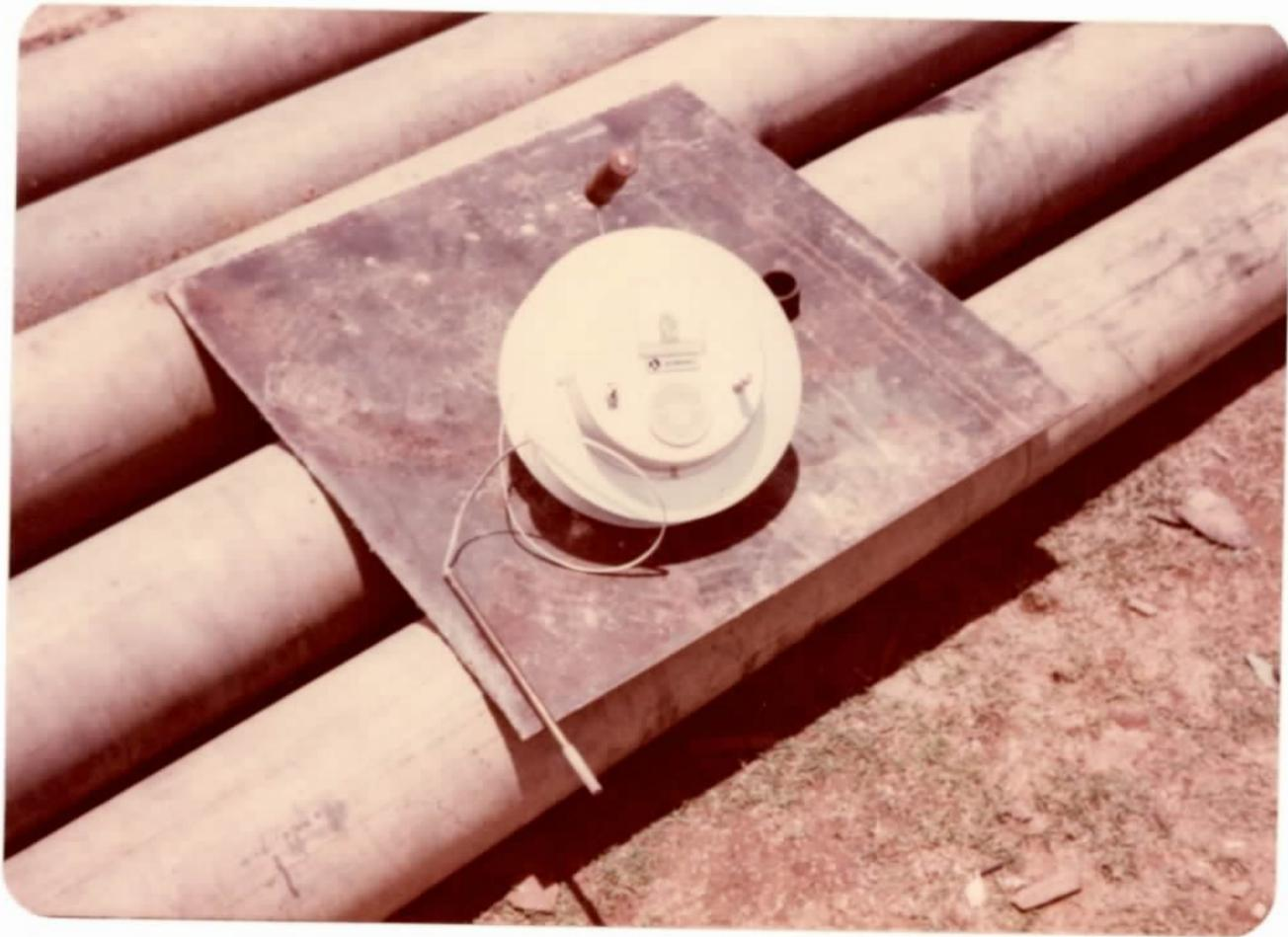
FOTO 26 - Aparelho "AUTRONIC" para medida do nível da água no furo (fabricado em Recife).
