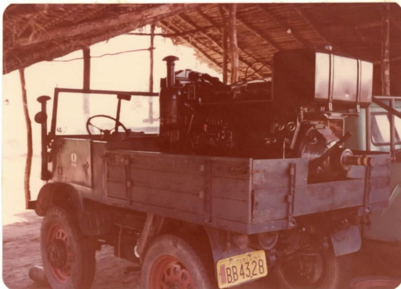
FOTO 29 - Bomba ESCO montada em caminhão para testes de vazão.
