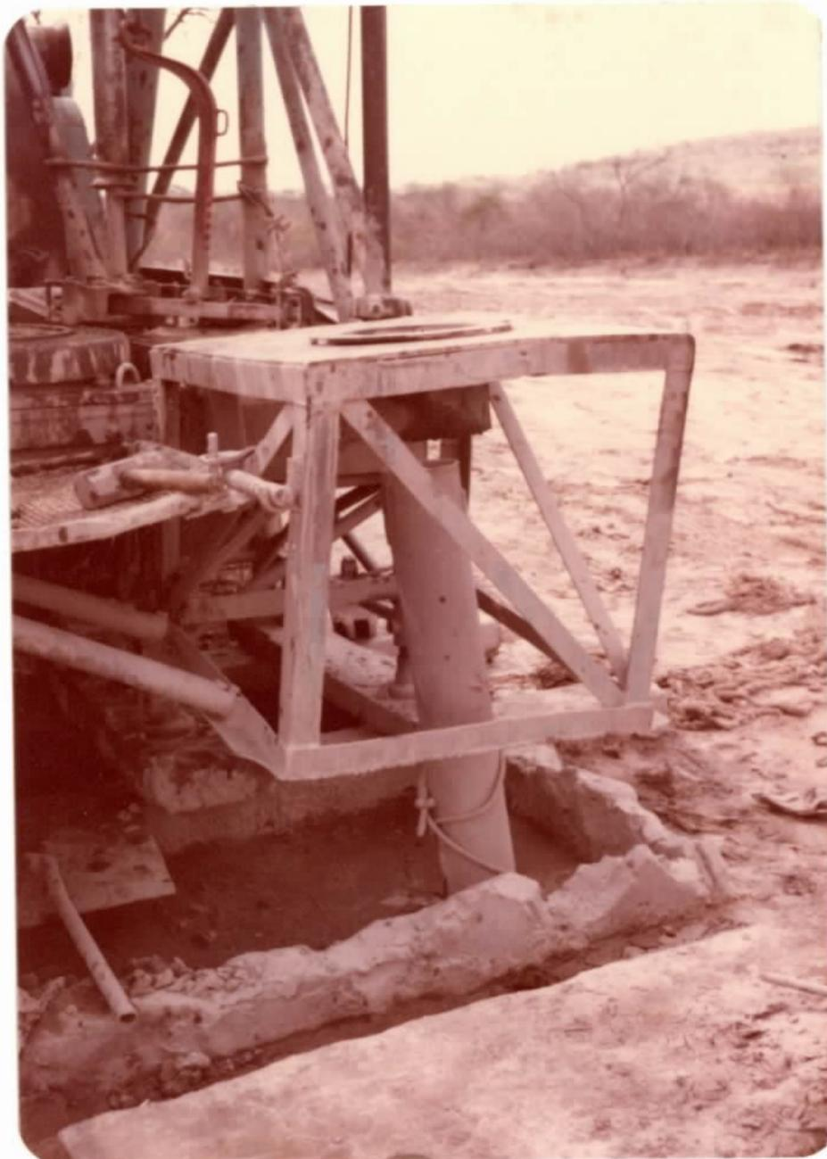
FOTO 2 - Mesa rotativa auxiliar da Failing 2500, usada no começo de furo, para abertura do furo que serve como "bainha do Kelly".
