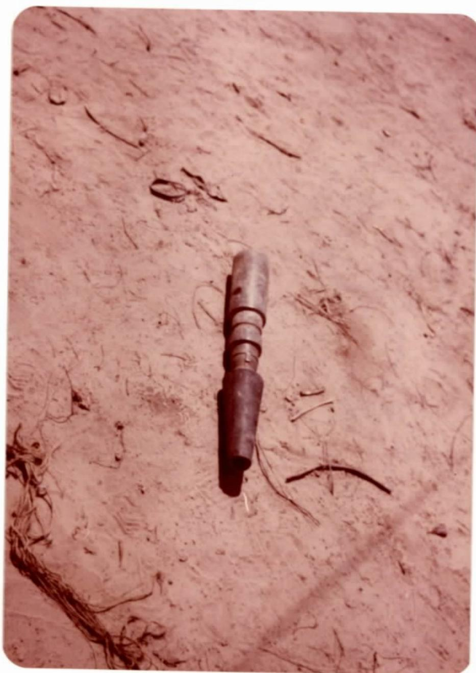
FOTO 18 - Cone de borracha usado na cimentação.
