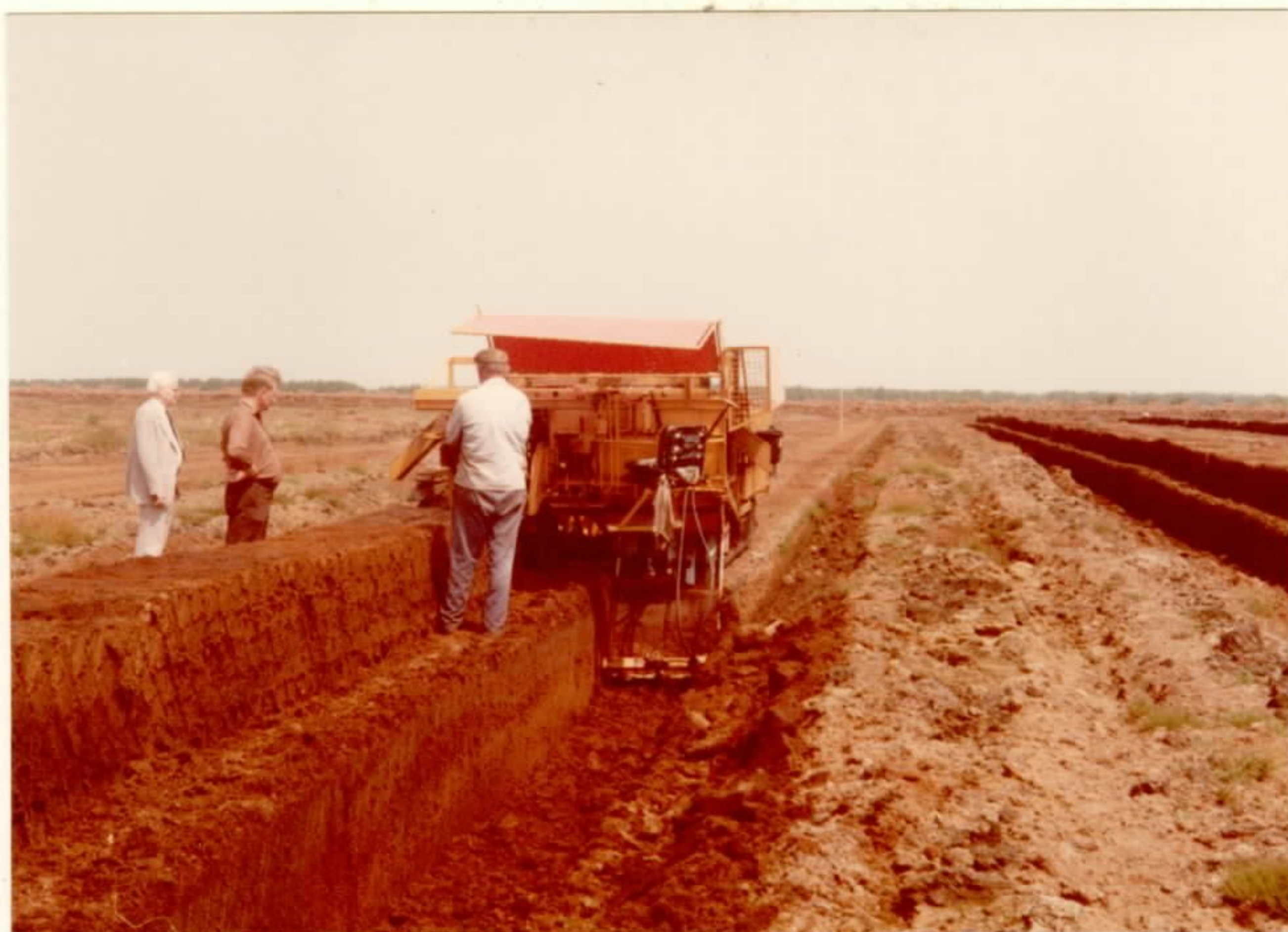
Foto 6 - Corte e empilhamento dos blocos de turfa da camada superior ("white peat").
