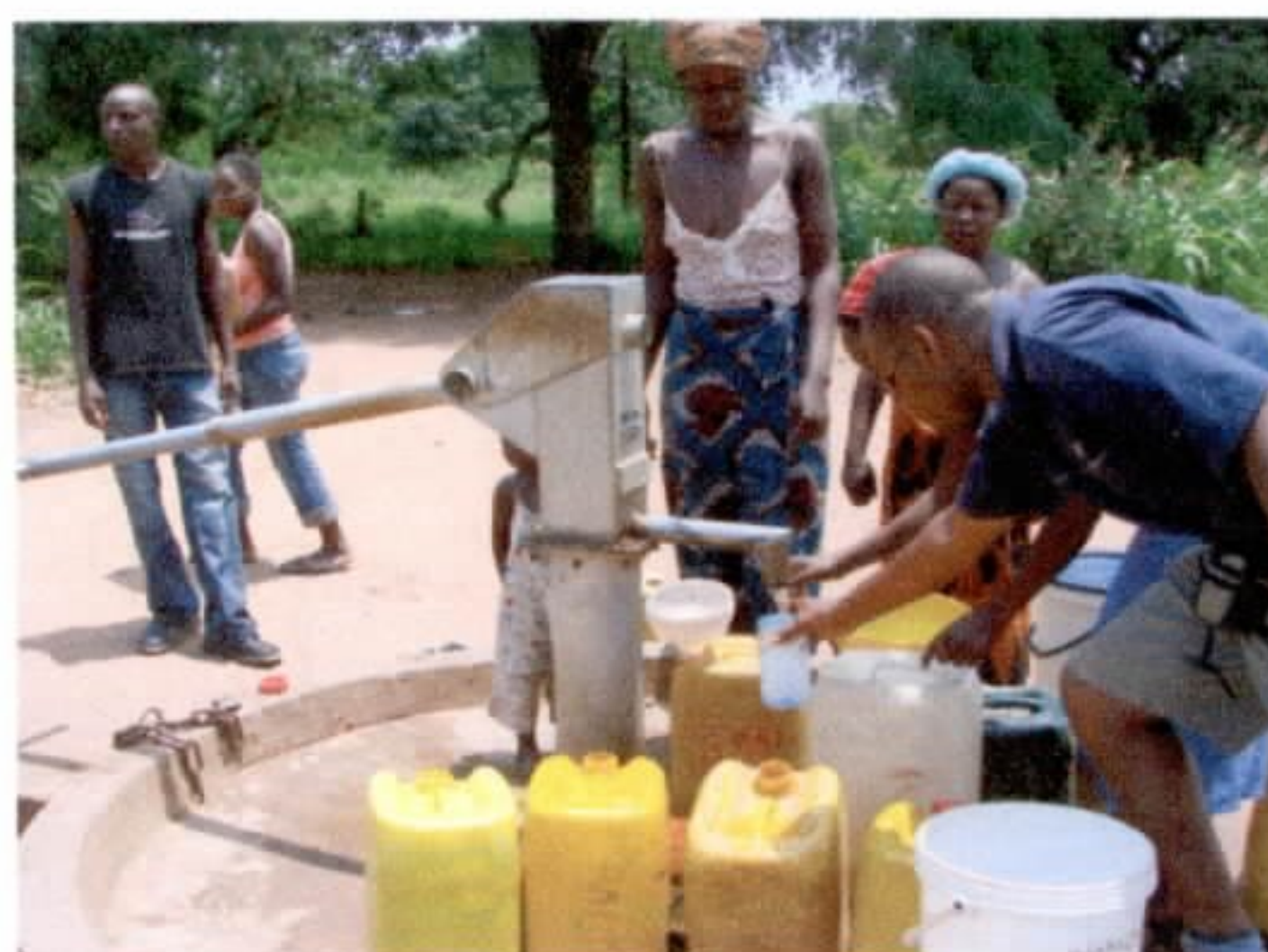
Foto 8 – Coleta de água em furo para análise de condutividade elétrica
