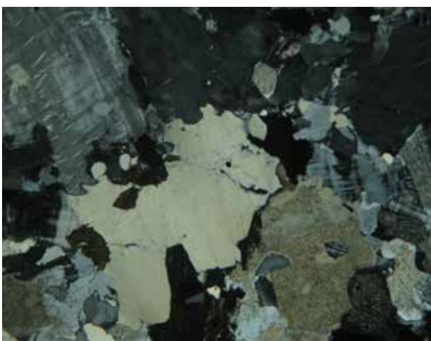
Figura 5.33 – Facies Fazenda Liberdade mostrando plagioclásio saussuritizado e feldspato(K) em uma textura granular hipidiomórfica; campo de 5mm, 25X, luz analisada
