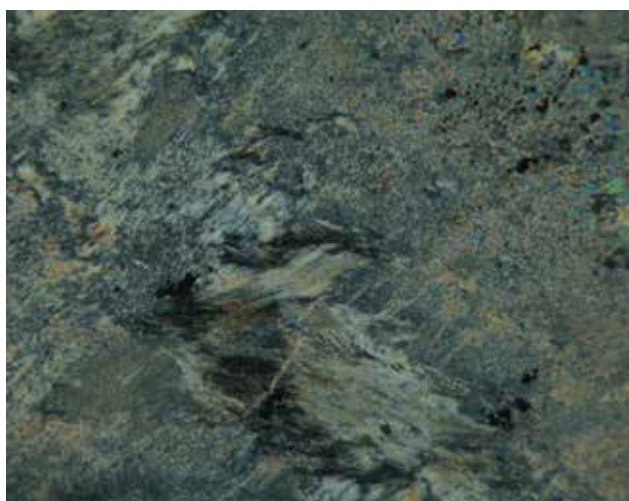
Figura 5.26 - Rocha peraluminosa constituída apenas por micas (muscovita e pirofilita), amostra da serra Negra de Betim; campo de 5mm, 25X, luz analisada
