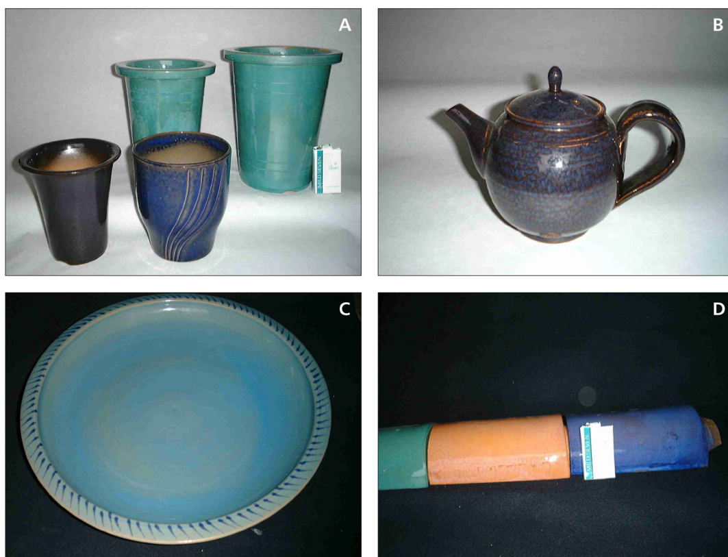
Figura 70 - Materiais cerâmicos esmaltados produzidos por pesquisa tecnológica da Companhia Riograndense de Mineração (CRM) em conjunto com o Instituto de Pesquisa Cerâmica de Shigaraki (Japão) para a utilização da argila e da cinza de carvão de Candiota: (A) vasos, (B) bule, (C) prato e (D) telhas. Fotos cedidas pelo geólogo Fernando Dable de Mello, CRM. Altura da escala (em A e C): ~9cm.
