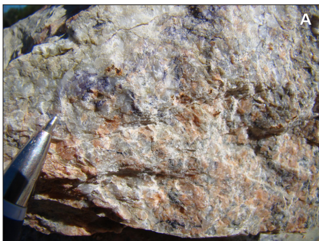
Figura 69 - (A) Granito cataclasado com disseminação de fluorita ± quartzo nas fraturas; (B) detalhe de superfície de fratura com preenchimento por quartzo ± fluorita roxa.
