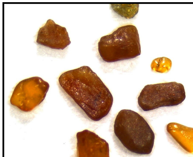
Figura 79 - Amostra de Monazita no microscópio Leica, 20x.
