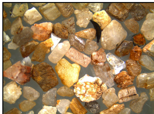
Figura 80 - (A) Espectro EDS de amostra de barita; e (B) amostra no microscópio Leica, 20x.
