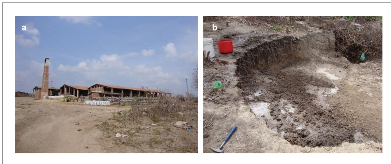
Figura 6.8 - a) Olaria de pequeno porte, produtora de tijolos; b) Extração de argila em terraço fluvial, atividade rudimentar com uso de equipamentos manuais.
