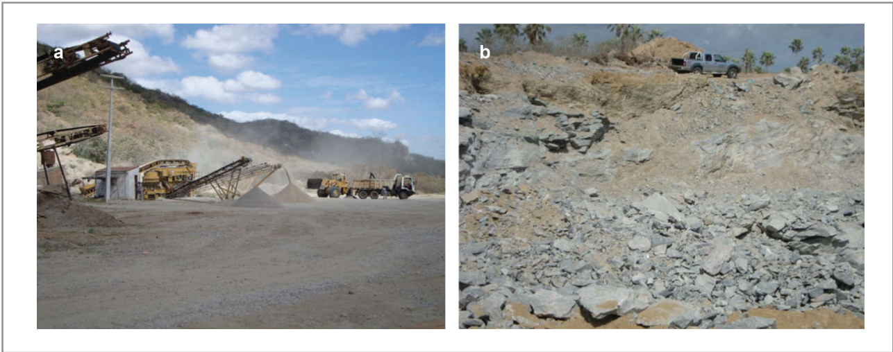
Figura 6.4 - a ) Sistema de britagem e pilha de estoque; b) Frente de lavra em bancadas de aproximadamente de 6 m de altura, recém-detonada com material pronto para ser transportado ao britador (Ponto IB 150 - UTM: 397969; 9639018).
