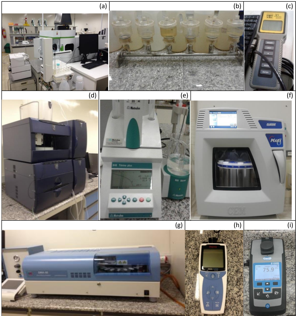
Figura 46- Equipamentos utilizados: ICP-OES Optima 8000 (a), Sistema de Filtração SM 16829 (b), Condutivímetro Ysi 30 (c), Cromatógrafo Iônico ICS-5000 (d), Titrimetro 848 Plus (e), Microondas XP 1500 Plus (f), DMA-80 (g), pHmetro Oryon 3 Star (h) e Turbidímetro HACH 2100 Q (i).
