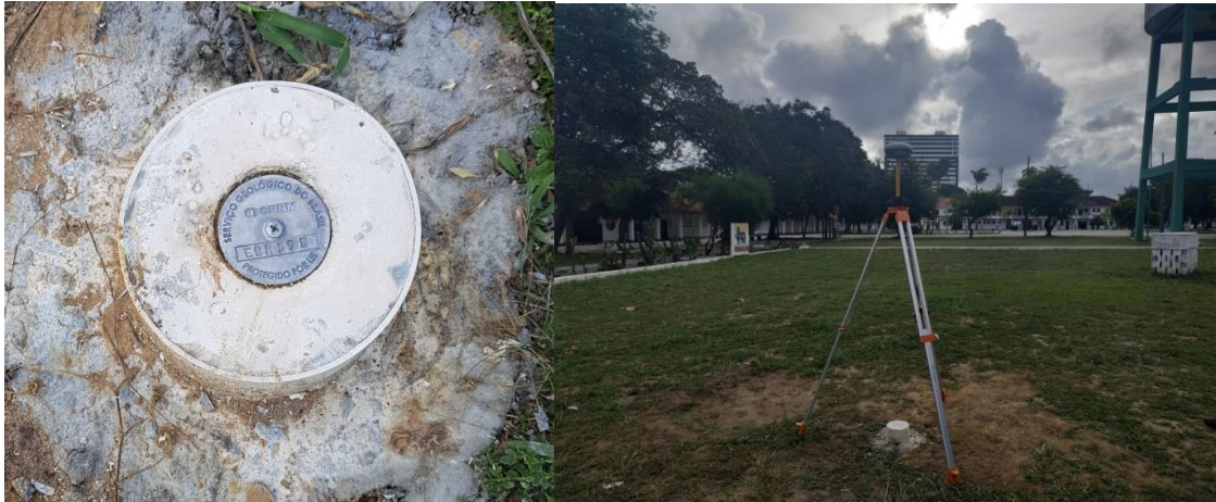
Figura 03: Instalação de chapas identificadoras. Localização marco geodésico da CPRM
