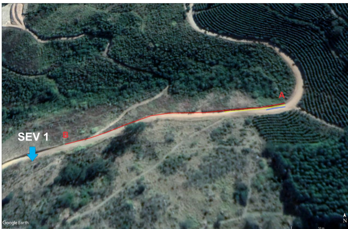
Figura 4 - SEV 1 e CE 1 (espaçamento= 1; 3 e 5m), A e B identificam, respectivamente, início e fim do CE. Ponto A: (X=46°40'54,07"; Y=22°11'28,07"), Ponto B: (X=46°41'03,06"; Y=22°11'29,11")
