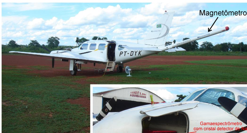
**Fotografia 1** - Avião equipado com magnetômetro do tipo vapor de céσιο montado na cauda da aeronave (tipo stinger). Este magnetômetro mede o campo magnético total a cada 0,1 s..
