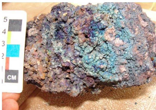
Figura 14: Amostra típica de gossan da região de Nova Brasilândia D'Oeste, com iridescência e textura boxwork .
