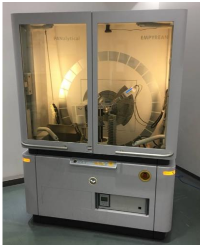
Figura 20: Esquerda – Difratorômetro EMPYREAN da PANalytical. Direita – Amostra preparada e prensada dentro do porta-amostra.
