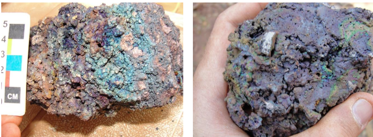
Figura 5: Fotos de amostras de gossans da região de Nova Brasilândia D'Oeste, com coloração iridescente e textura boxwork. Fonte: Bergami e Prado (2019).
