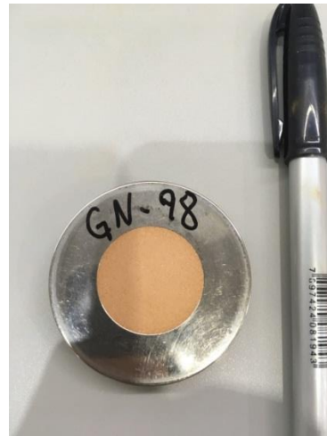
Figura 20: Esquerda – Difratorômetro EMPYREAN da PANalytical. Direita – Amostra preparada e prensada dentro do porta-amostra.
