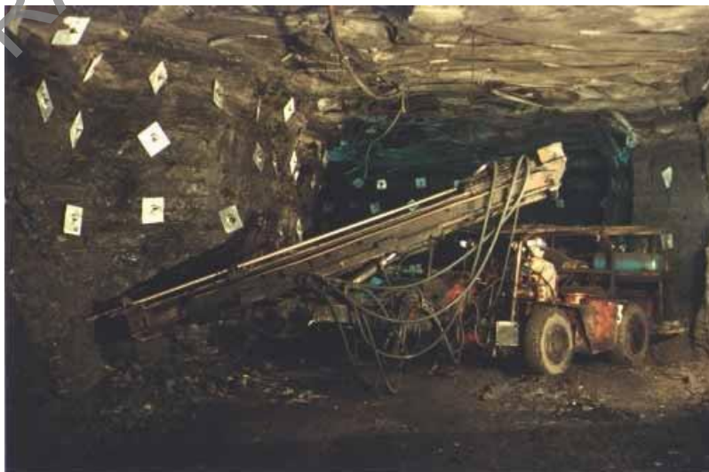
Figura 55 – Método de câmara e pilares adotado pela Carbonífera Metropolitana S/A.
