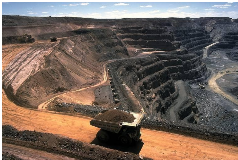
Figura 54 – Lavra em bancadas; mineração de carvão (China).
