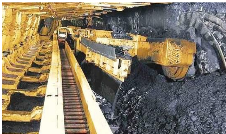
Figura 56 – Método longwall mining na lavra de carvão.
