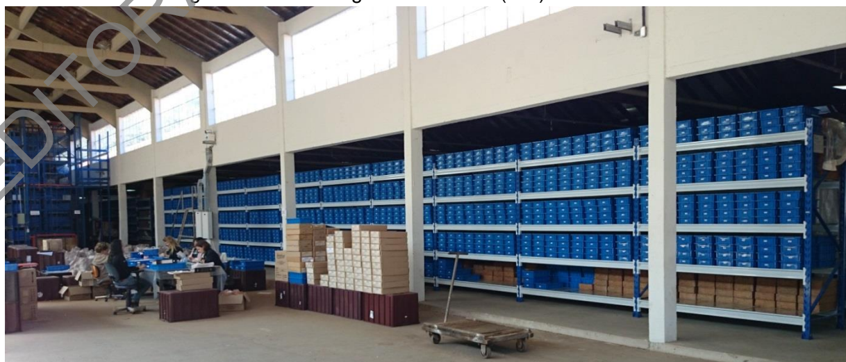
Figura 20 – Prateleiras de armazenamento das caixas de acondicionamento dos furos de sondagem na litoteca regional de Caeté (MG).
